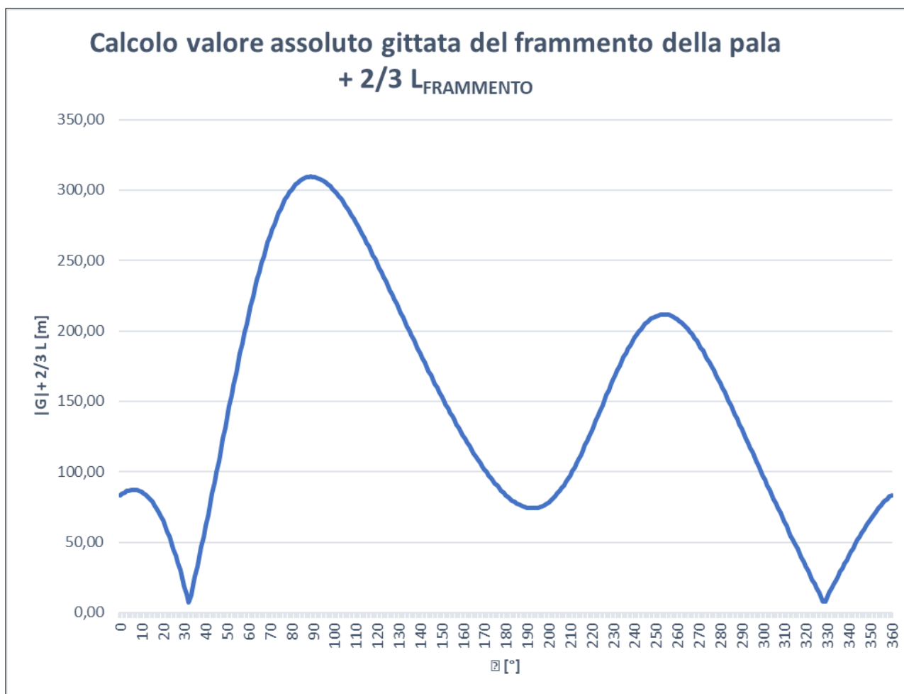
Figura 8.4: Grafico del valore assoluto della gittata del frammento della pala di lunghezza 10\text{ m} + \frac{2}{3} L_{\text{FRAMMENTO}}
