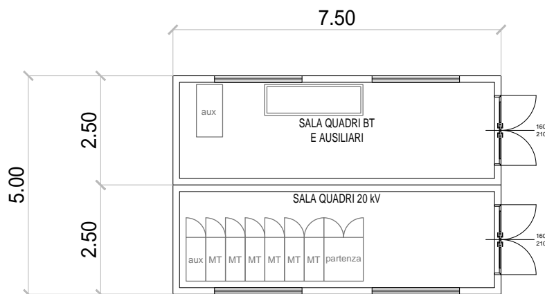
Figura 5.3: Pianta della cabina quadri MT.
