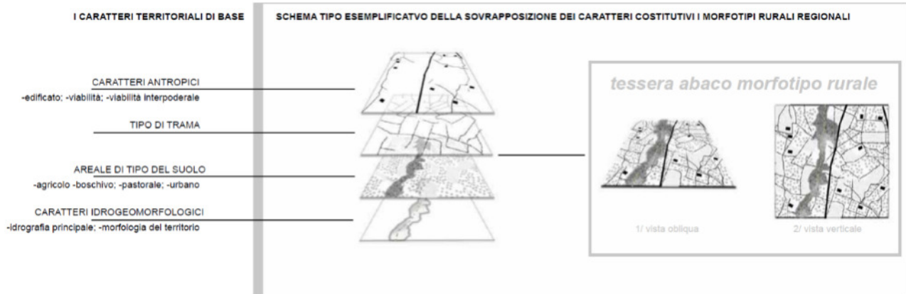
Figura 18. Scomposizione del territorio in “caratteri territoriali di base”, layer strutturali che si sovrappongono l’uno all’altro fino a definire una specifica identità spaziale e strutturale del luogo (rif. Allegato 3.2 - Descrizioni strutturali di sintesi – PPTR, stralcio della “Scheda tipo esemplificativo della sovrapposizione dei caratteri costitutivi i morfotipi rurali regionali”).
