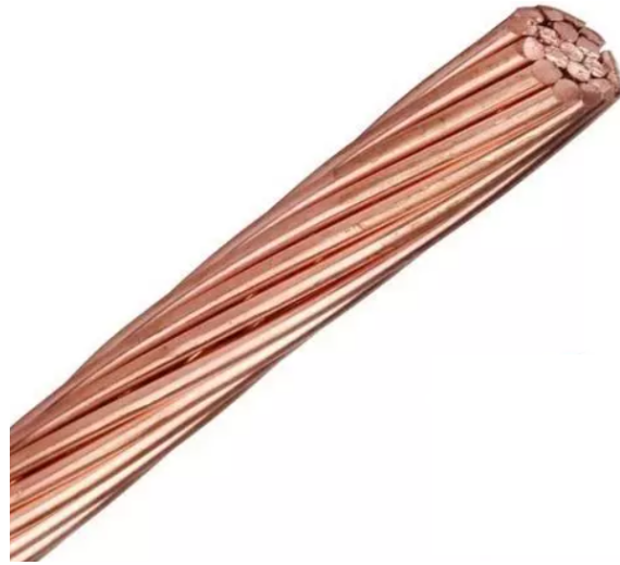
Figura 1. Particolare di una corda di rame da 50 mm 2 (rappresentazione esemplificativa)
