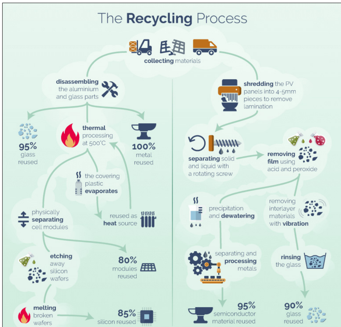
Figura 75. Il processo di riciclo dei moduli fotovoltaici a base silicea e dei sottoprodotti della dismissione di impianti fotovoltaici. Fonte: www.greenmatch.co.uk/blog/2017/10/the-opportunities-of-solar-panel-recycling (Ultimo accesso: marzo 2021).
