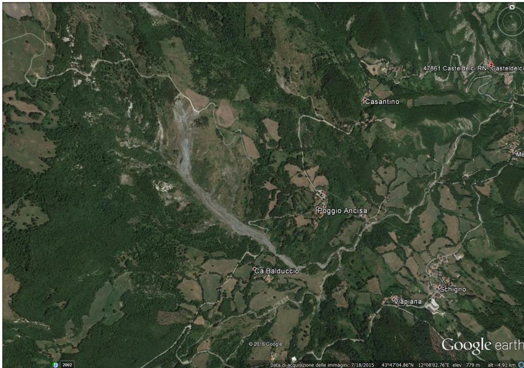
Fig. 5 – La frana di Poggio Ancisa del 2009 emblematica dell'instabilità diffusa del tipo di substrato in cui dovrebbe insediarsi l'impianto progettato, che determinerebbe un rischio elevato per il territorio nonché per la viabilità, le infrastrutture, gli insediamenti sparsi, le reti idriche artificiali e per l'idrogeologia.
