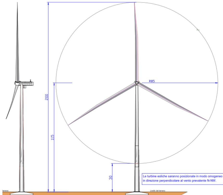
Figura 6 - Struttura aerogeneratore.
