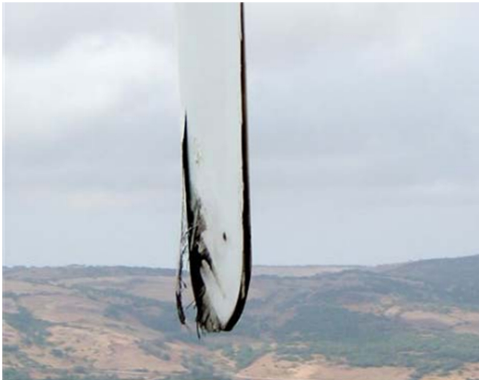
Figura 5 - Estremità di pala danneggiata da fulminazione atmosferica
