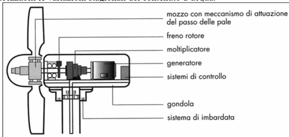
Figura 6 - Schema di principio di un aerogeneratore
