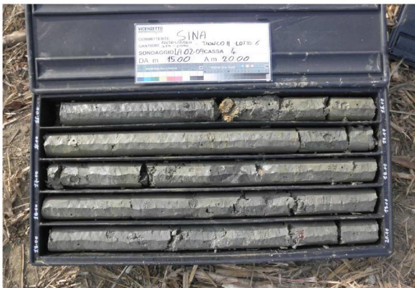
Figura 9.7a – Sondaggio SOT-VE-070: esempio di depositi di copertura lato Alba (unità 4)
