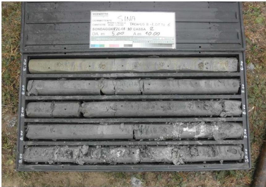
Figura 9.7b – Sondaggio IOV-MO-045: esempio di depositi pliocenici (unità 5)
