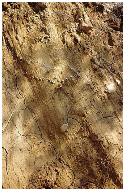
Immagine 02 - Strie di movimento sulla scarpata principale
