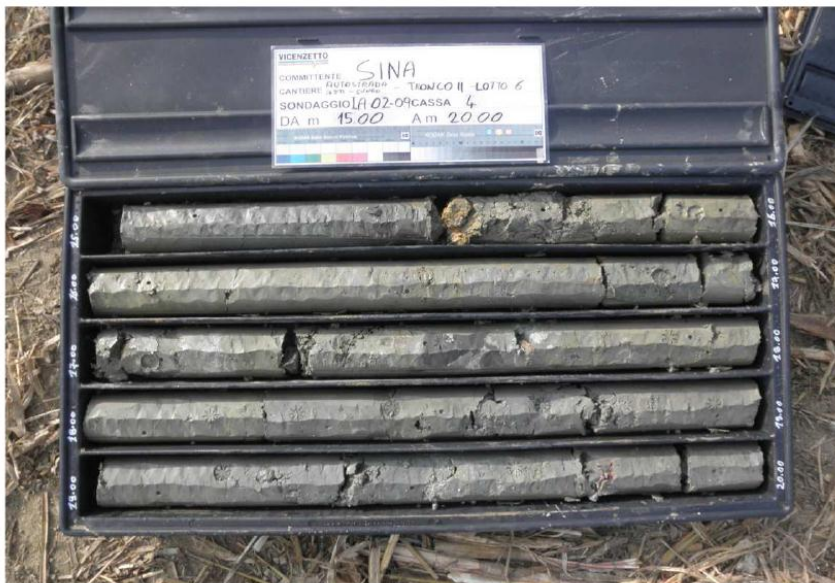
Figura 4.8 – Sondaggio SOT-VE-070: esempio di depositi di copertura lato Alba (unità 4)
