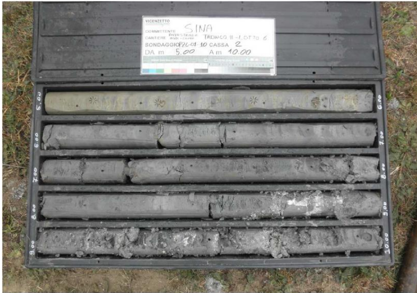
Figura 4.9 – Sondaggio IOV-MO-045: esempio di depositi pliocenici (unità 5)
