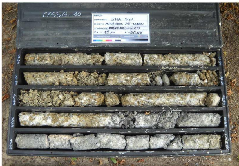
Figura 4.11 – Sondaggio IOM-MO-070: esempio di roccia gessifera (unità 6)
