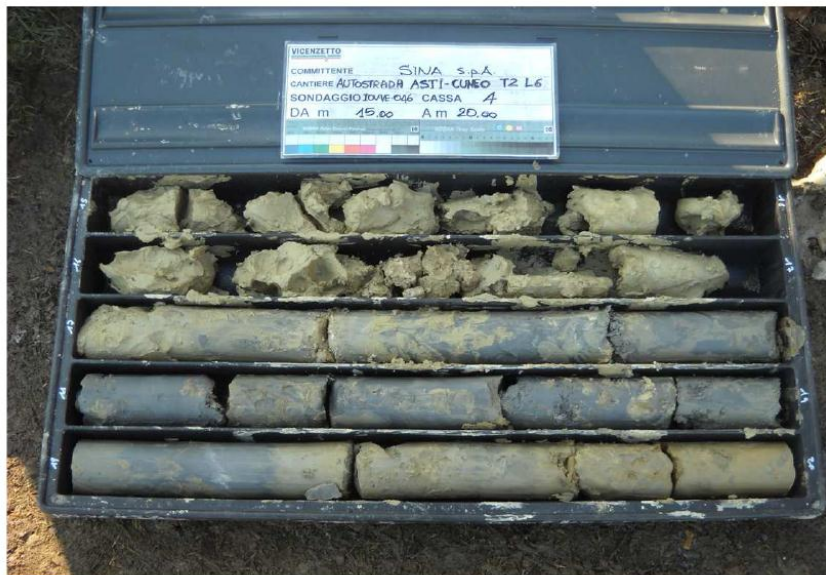
Figura 4.10 – Sondaggio IOV-VE-046: esempio di argilla marnosa tra m 17 e m 20 (depositi pliocenici) (unità 5)
