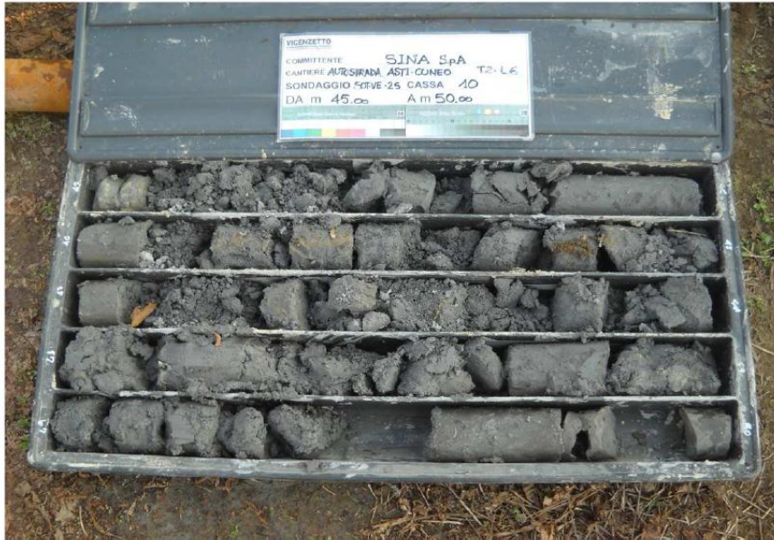
Figura 4.7 – Sondaggio SOT-VE-025: esempio di lenti sabbiose all'interno del substrato marnoso (unità 3 e 7a)
