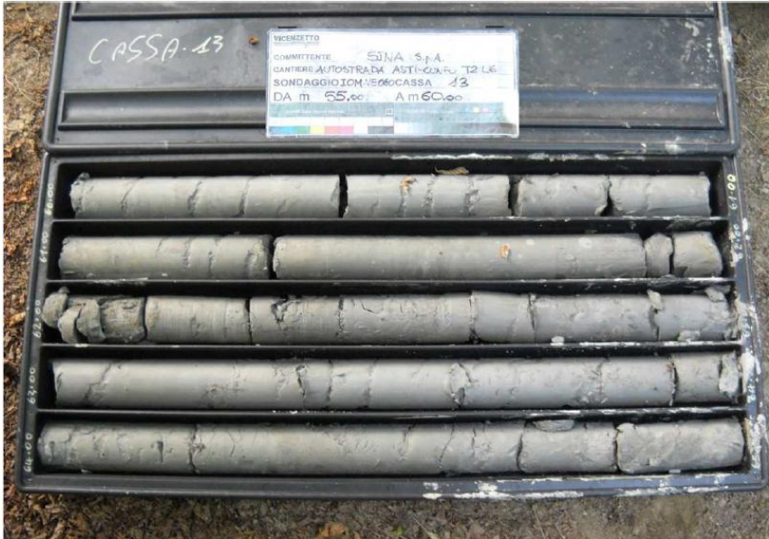
Figura 4.12 – Sondaggio IOM-MO-060: esempio di marna (unità 7)
