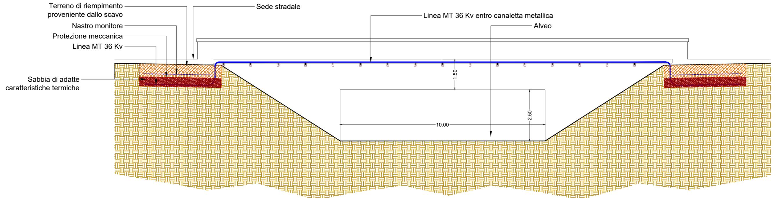
Sezione attraversamento torrente a mezzo di realizzazione ponte - scala 1:100
