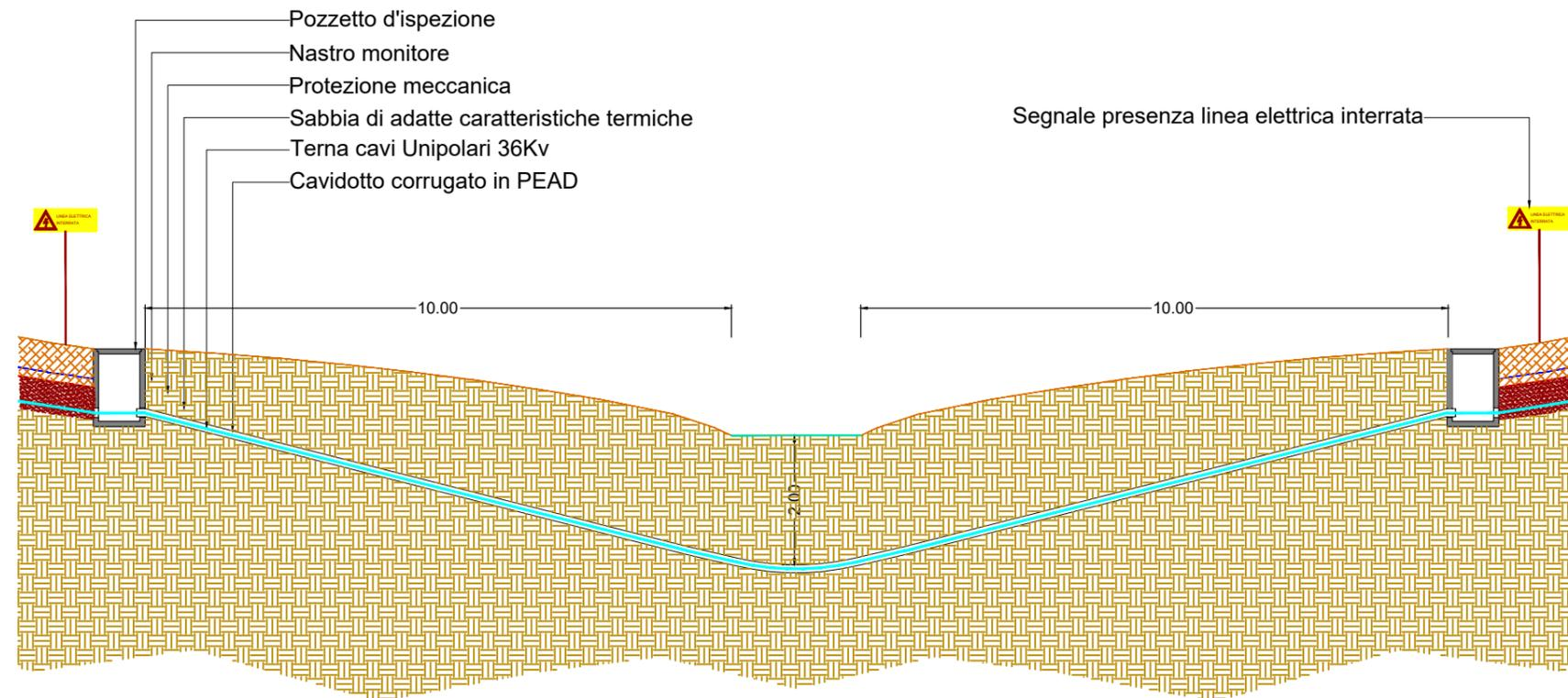
Sezione attraversamento torrente a mezzo di trivellazione orizzontale controllata (T.O.C.) - scala 1:100
