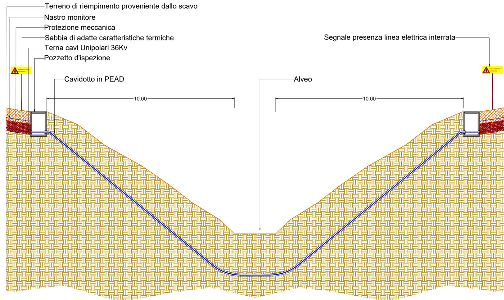
Sezione attraversamento torrente a mezzo di trivellazione orizzontale controllata (T.O.C.) - scala 1:100
