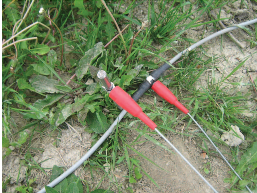
Stendimento linea elettrica profilo di rilievo C; elettrodi passivi.
