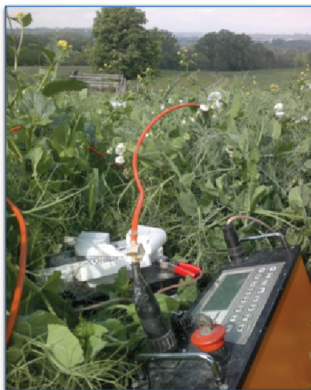
Georesistivometro multielettrodico ARES 200E con elettrodi attivi.
