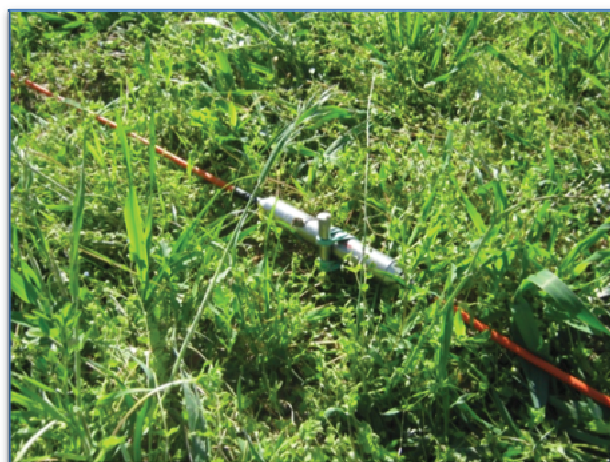
Elettrodo collegato ad un picchetto in ottone
