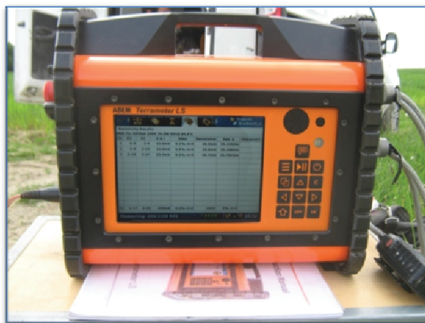
Georesistivometro multielettrodico ABEM Terrameter LS con elettrodi passivi.
