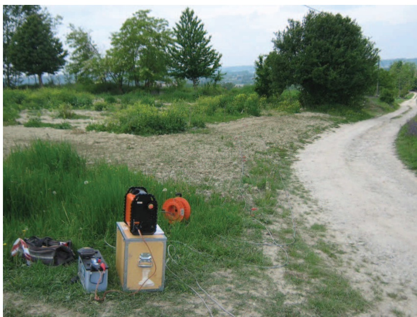
Unità d'acquisizione ABEM Terrameter LS.
