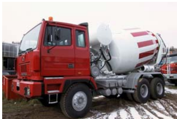
Fig. 6.4.4 Esempio di autotelaio con betoniera da circa 265 kW
