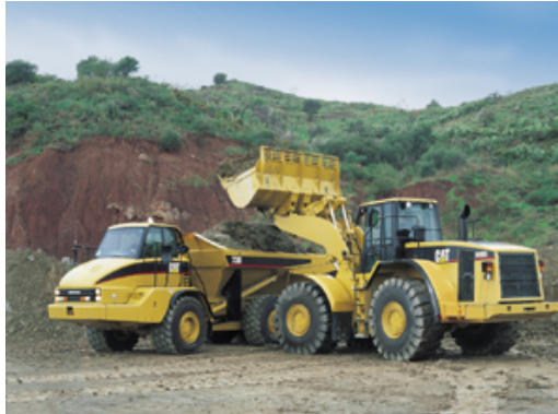
Fig. 6.4.5 Esempio di pala meccanica da circa 200 kW
