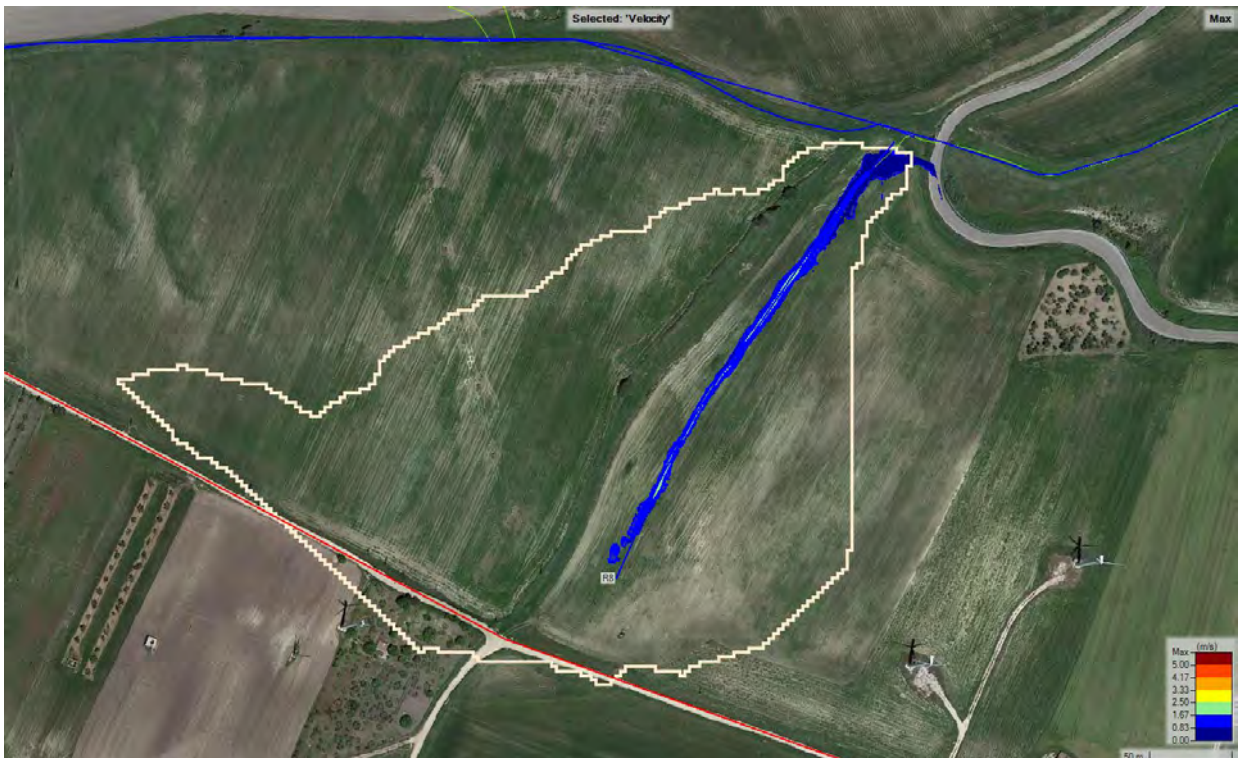
Figura 85. Mappa delle velocità massime. Sottobacino A8, TR=200 anni (velocità espressa in metri al secondo). In bianco il perimetro del sottobacino.
