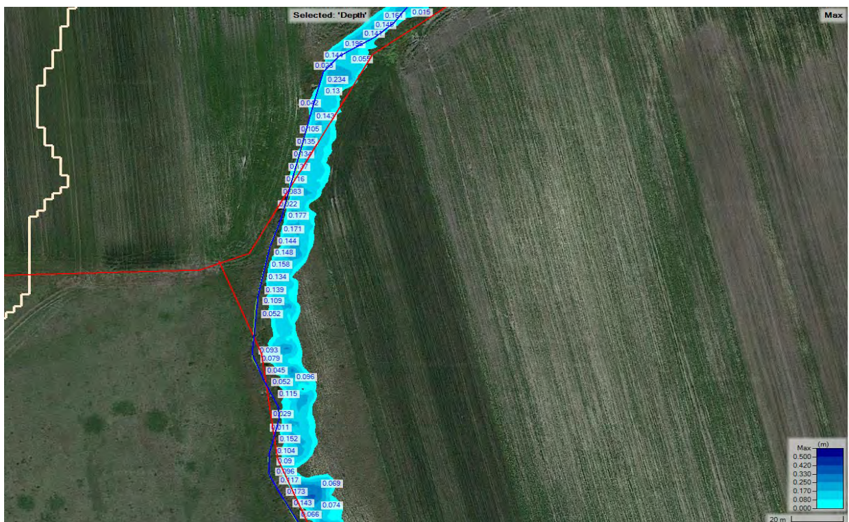
Figura 80. Impronta di allagamento in corrispondenza del cavidotto (in rosso) all'interno del sottobacino A4.
