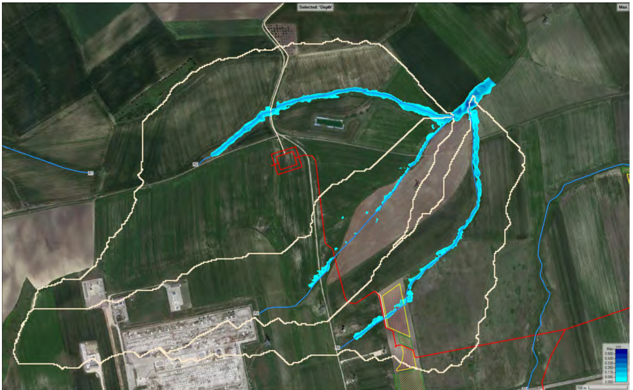
Figura 71. Mappa delle inondazioni. Sottobacini A2,A3,A4, TR=200 anni (tiranti espressi in metri). In bianco i perimetri dei sottobacini.
