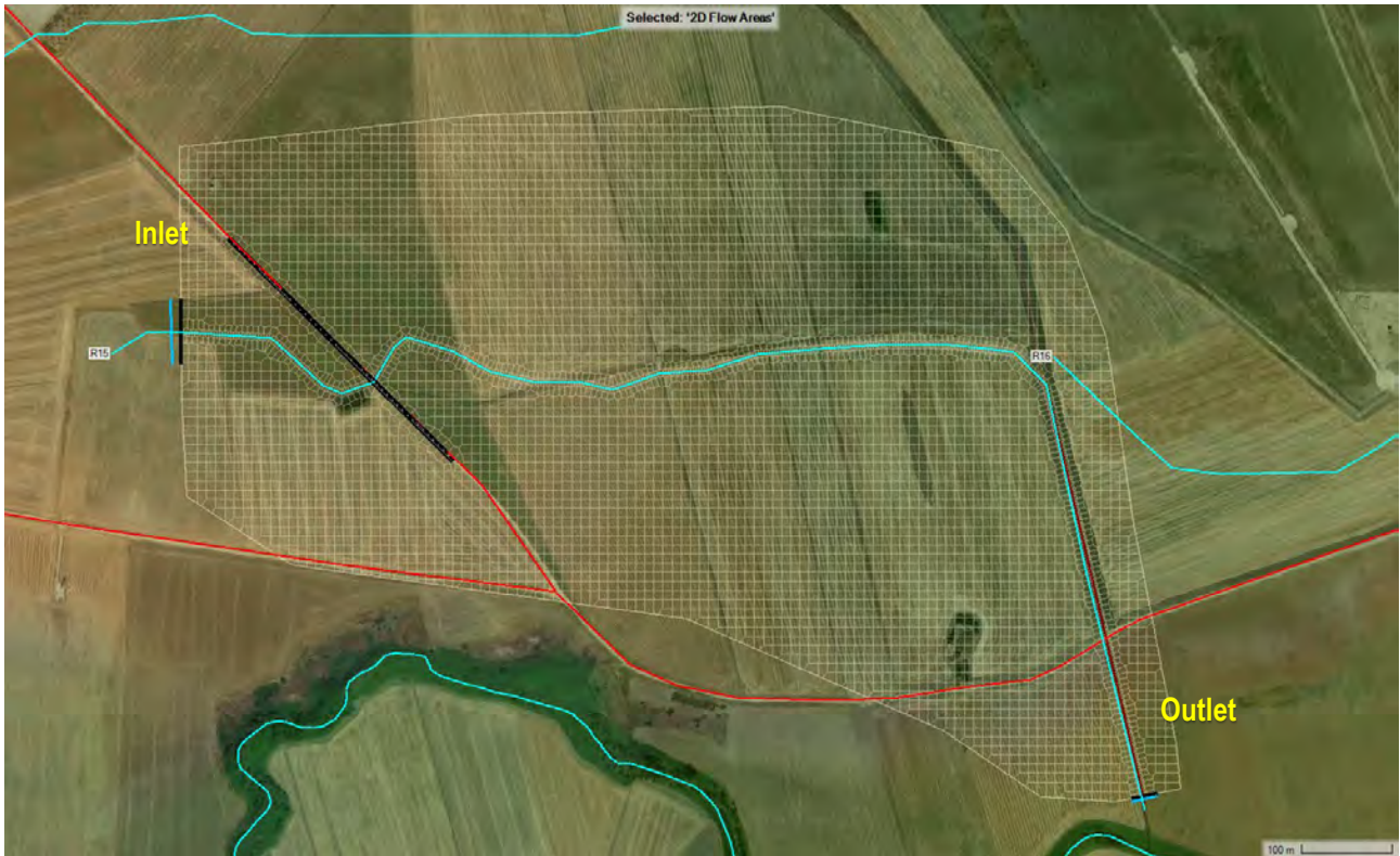
Figura 63. Dominio di calcolo per il sottobacino A15. Passo di cella pari a 10 m.
