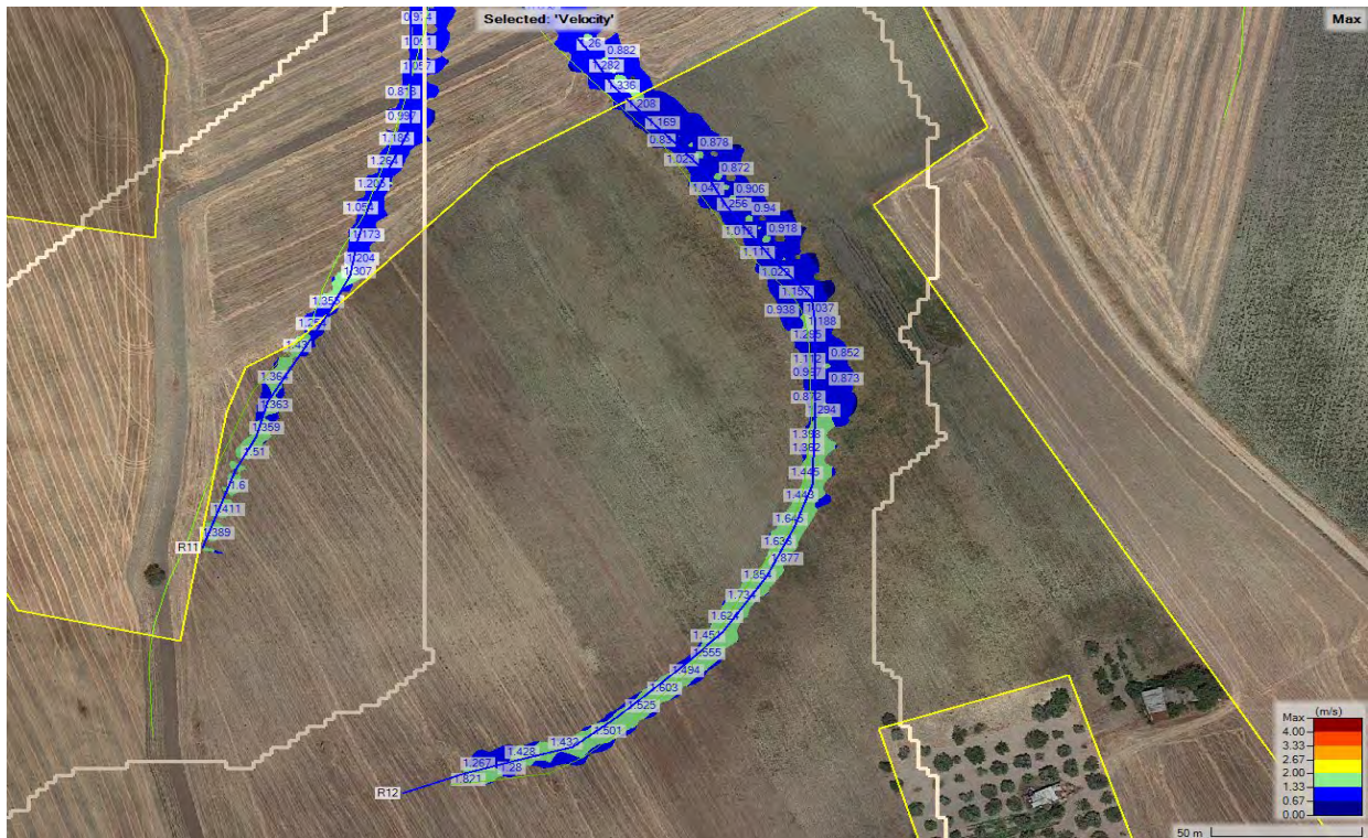
Figura 93. Velocità massime in corrispondenza dell'area del parco agrivoltaico all'interno dei sottobacini A11/A12.
