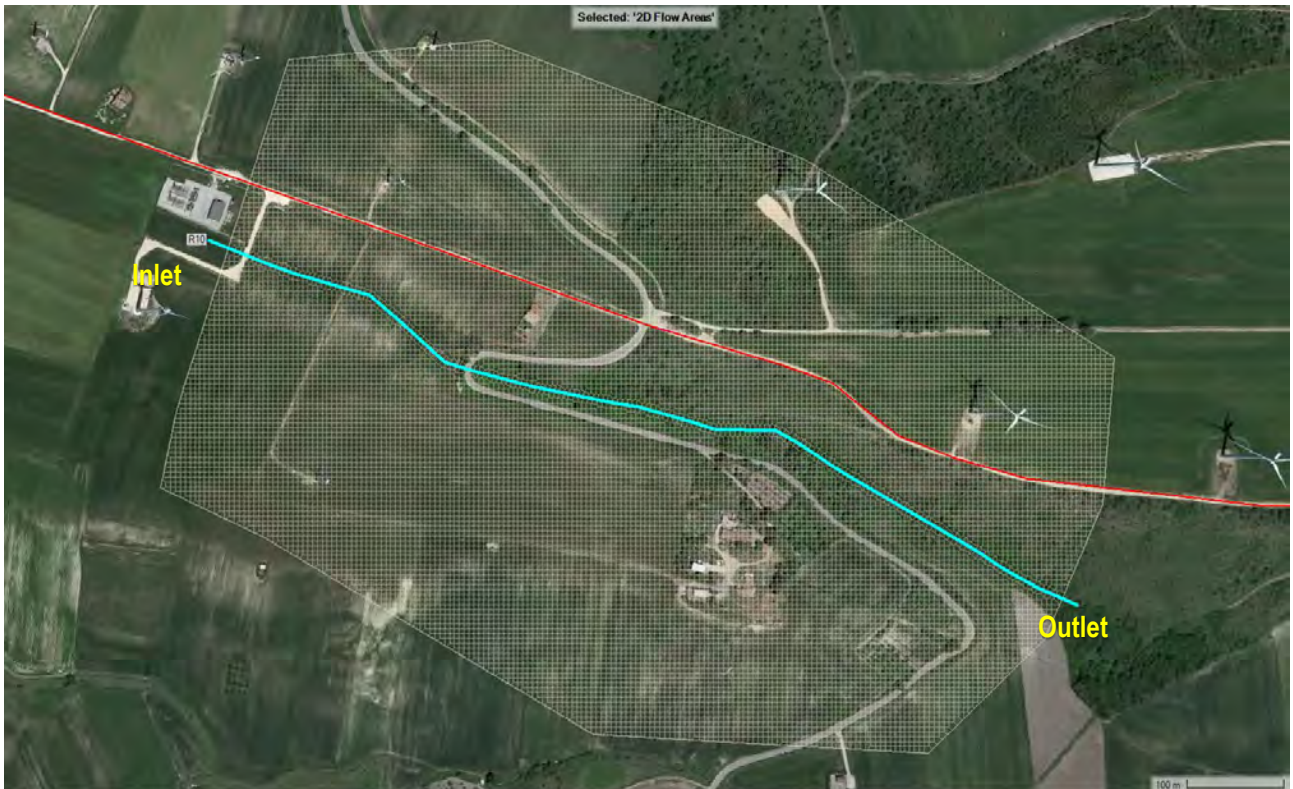
Figura 60. Dominio di calcolo per il sottobacino A10. Passo di cella pari a 5 m.
