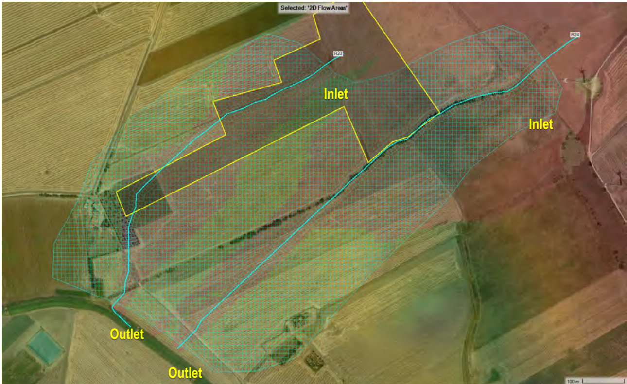
Figura 69. Dominio di calcolo per i sottobacini A23 e A24. Passo di cella pari a 10 m.
