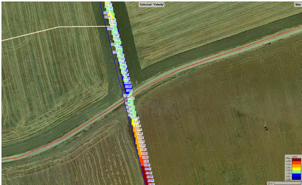
Figura 107. Impronta di allagamento in corrispondenza del cavidotto (in rosso) all'interno del sottobacino A15.
