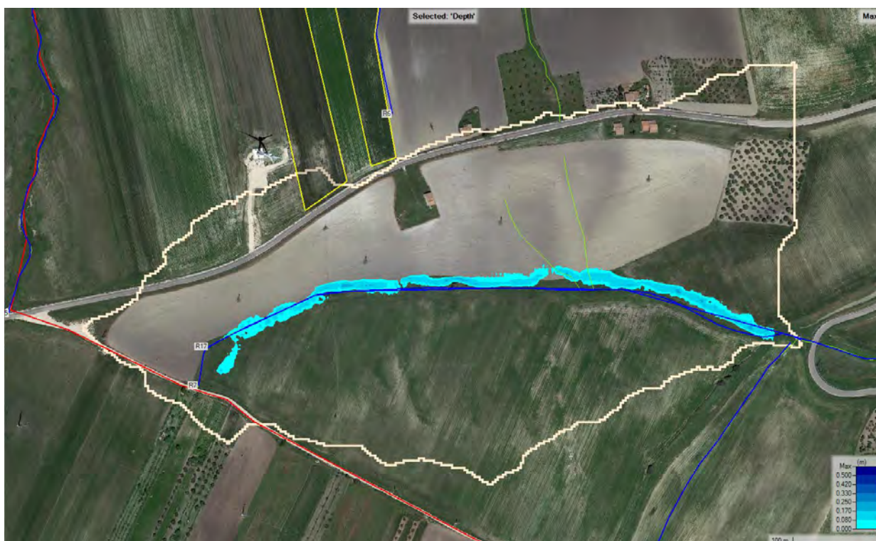
Figura 82. Mappa delle inondazioni. Sottobacino A7, TR=200 anni (tiranti espressi in metri). In bianco il perimetro del sottobacino.
