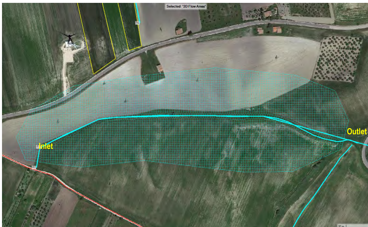
Figura 57. Dominio di calcolo per il sottobacino A7. Passo di cella pari a 5 m.
