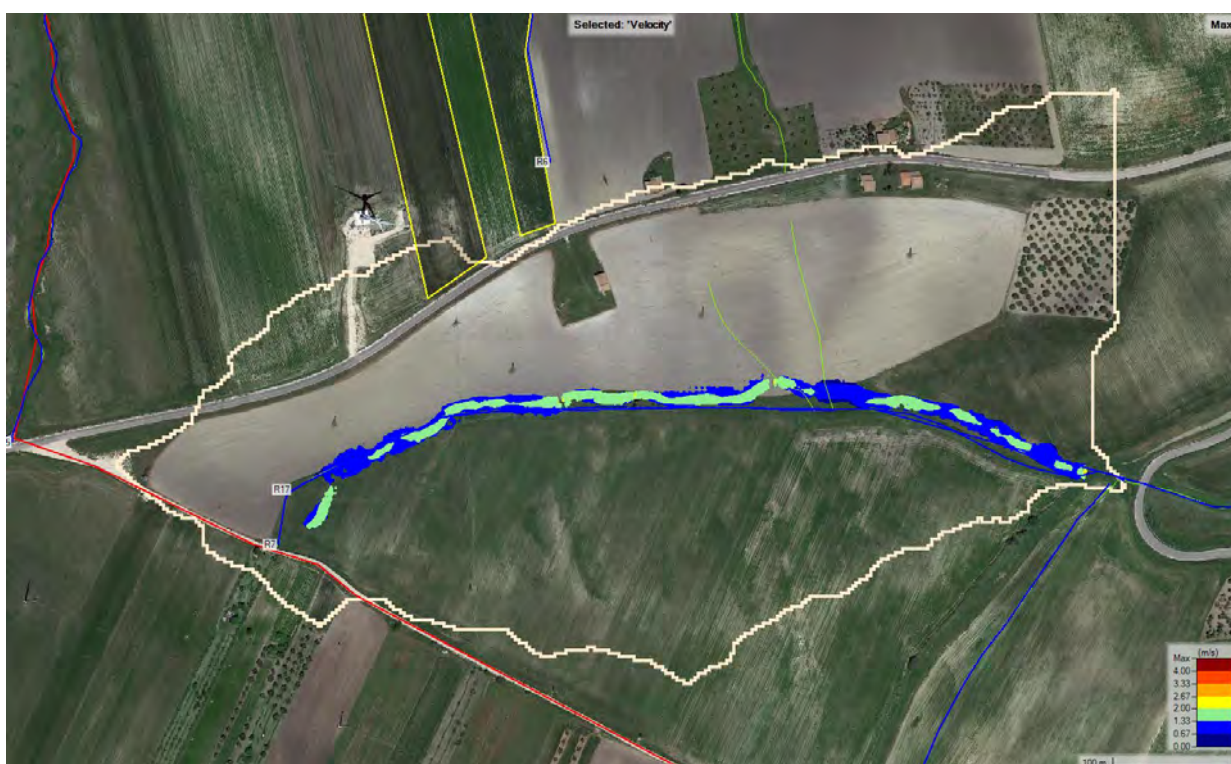
Figura 83. Mappa delle velocità massime. Sottobacino A7, TR=200 anni (velocità espressa in metri al secondo). In bianco il perimetro del sottobacino.
