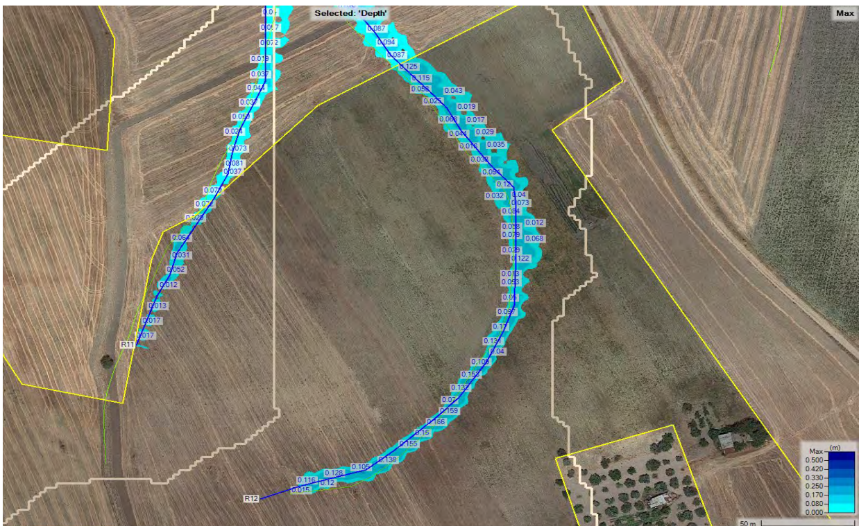
Figura 92. Impronta di allagamento in corrispondenza dell'area del parco agrivoltaico all'interno dei sottobacini A11/A12.
