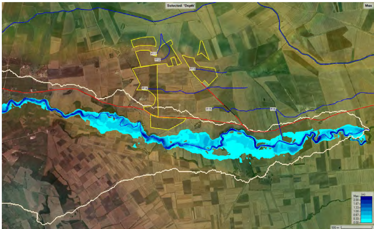
Figura 86. Mappa delle inondazioni. Sottobacino A9, TR=200 anni (tiranti espressi in metri). In bianco il perimetro del sottobacino.
