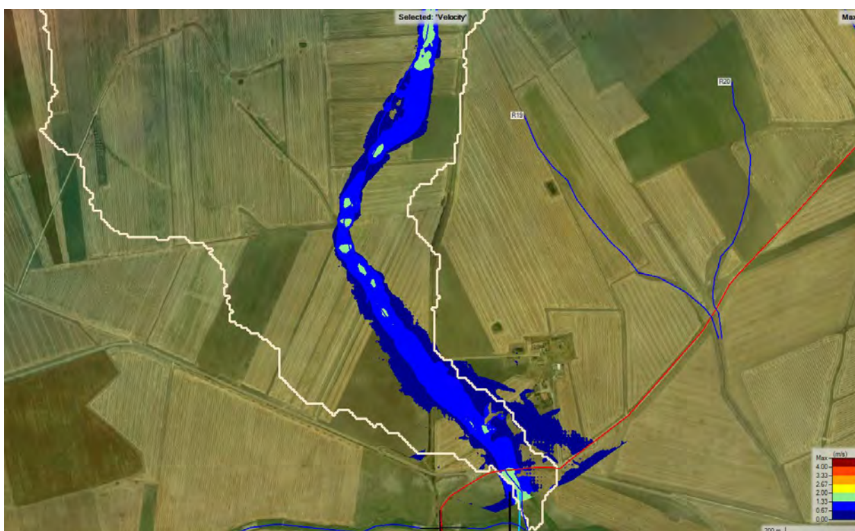
Figura 121. Mappa delle velocità massime. Sottobacino A18, TR=200 anni (velocità espressa in metri al secondo). In bianco il perimetro del sottobacino.
