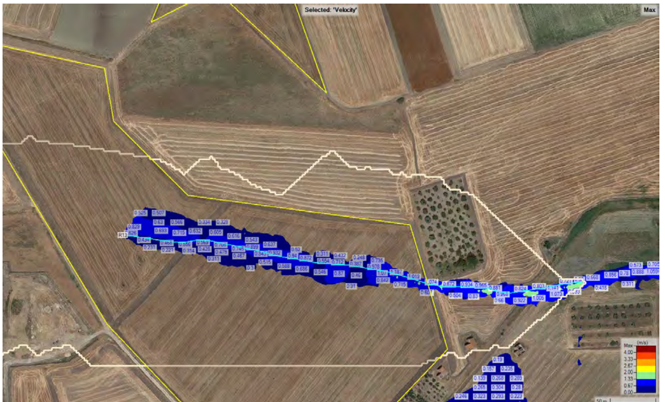
Figura 99. Velocità massime in corrispondenza dell'area del parco agrivoltaico all'interno del sottobacino A13.
