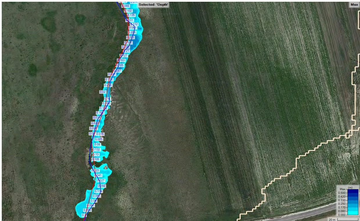
Figura 79. Impronta di allagamento in corrispondenza del cavidotto (in rosso) all'interno del sottobacino A4.
