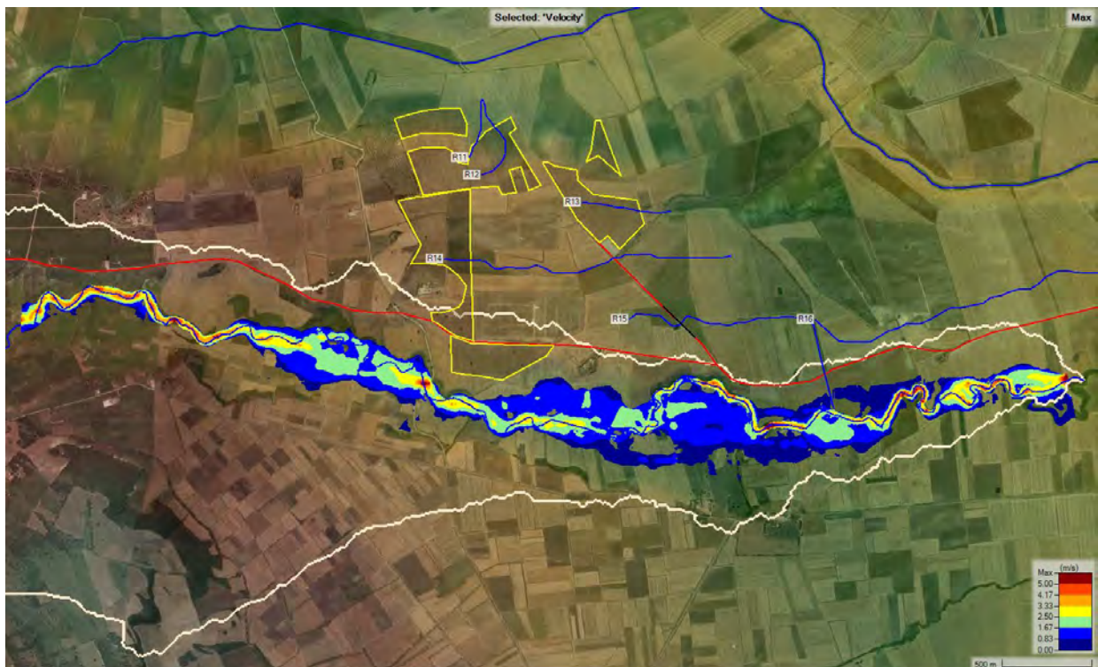
Figura 87. Mappa delle velocità massime. Sottobacino A9, TR=200 anni (velocità espressa in metri al secondo). In bianco il perimetro del sottobacino.
