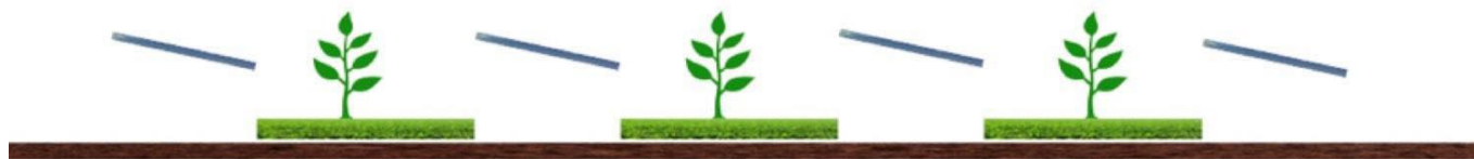
Figura 49: Sistema agrivoltaico in cui la coltivazione avviene tra le file dei moduli fotovoltaici, e non al di sotto di essi (TIPO 2)
