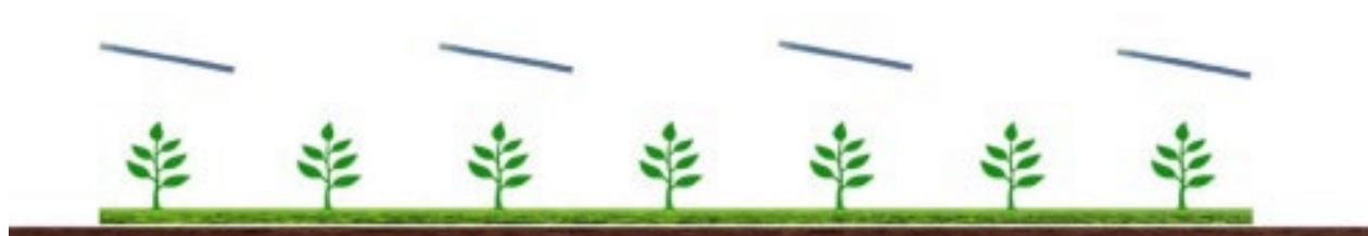
Figura 48: Sistema agrivoltaico in cui la coltivazione avviene tra le file dei moduli fotovoltaici, e sotto a essi (TIPO 1)
