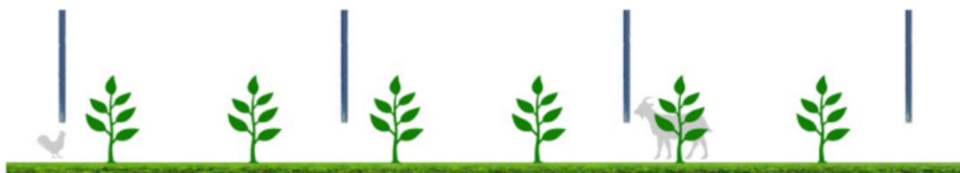
Figura 50: Sistema agrivoltaico in cui i moduli fotovoltaici sono disposti verticalmente. La coltivazione avviene tra le file dei moduli fotovoltaici, l'altezza minima dei moduli da terra influenza il possibile passaggio di animali (TIPO 3)
