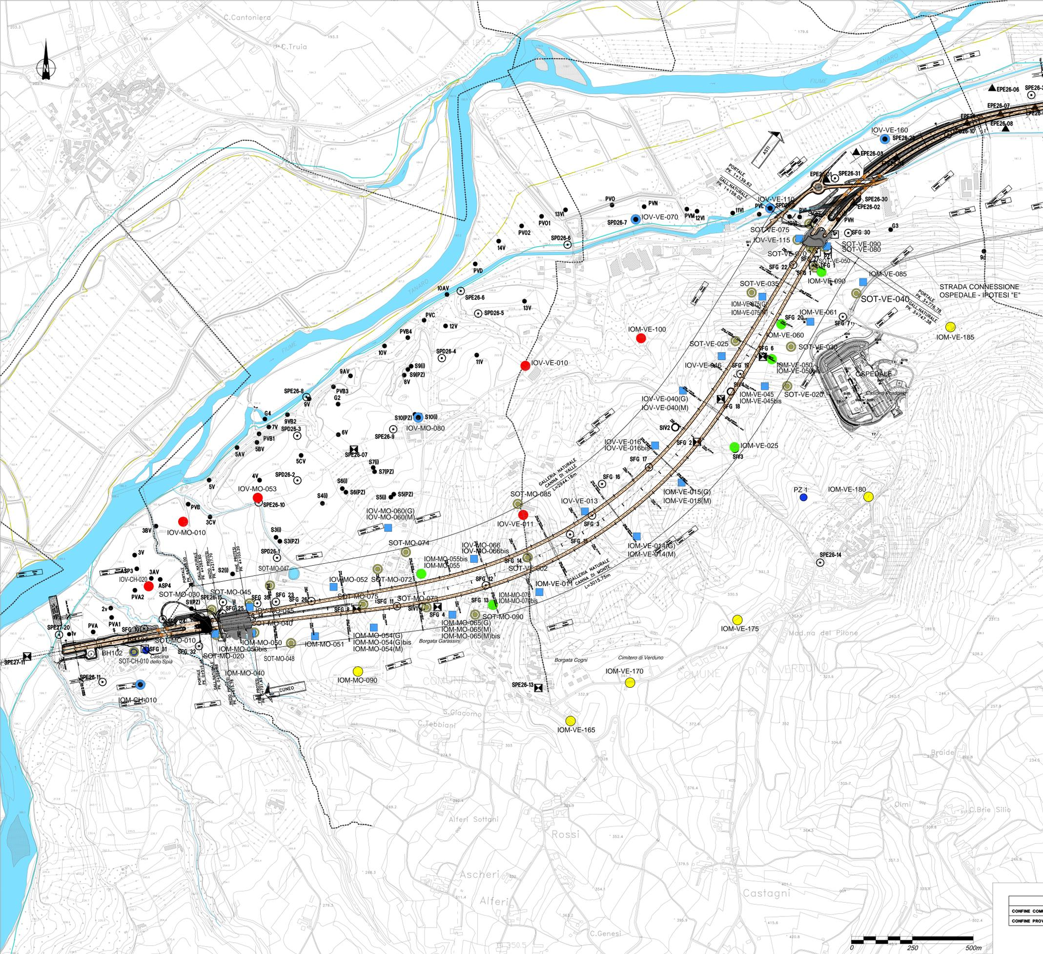
Sondaggi geotecnici a carotaggio continuo
