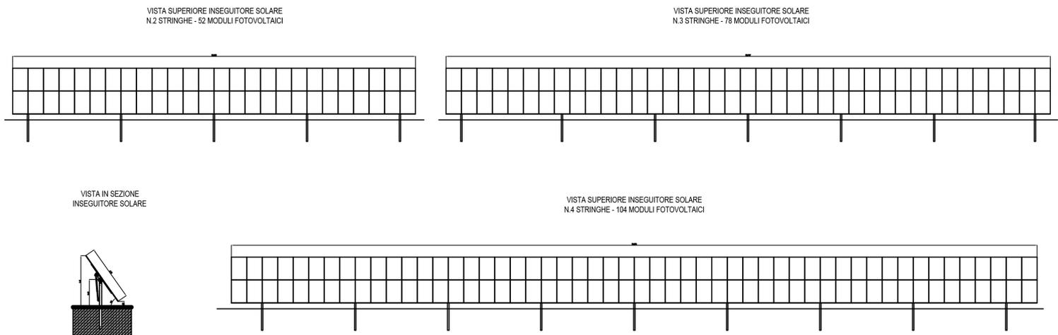
Figura 8 - Particolare longitudinale Tracker monoassiale
