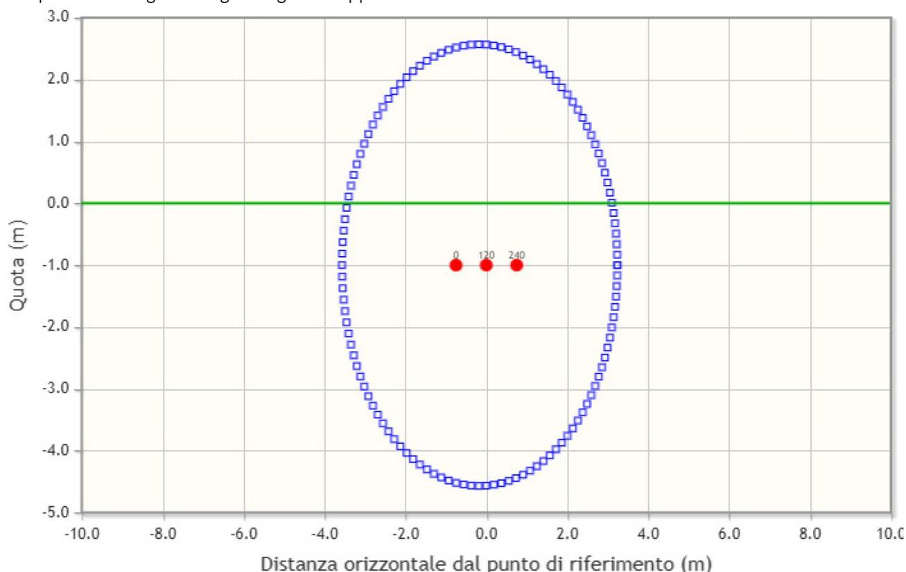
Figura 14 – Curva di induzione magnetica per cabina di trasformazione AT/bt 9000 kVA
