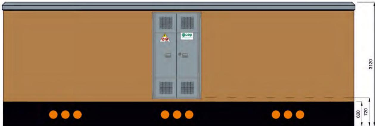
Figura 49 - Cabina elettrica monoblocco prefabbricata - Cabina elettrica generale di impianto
