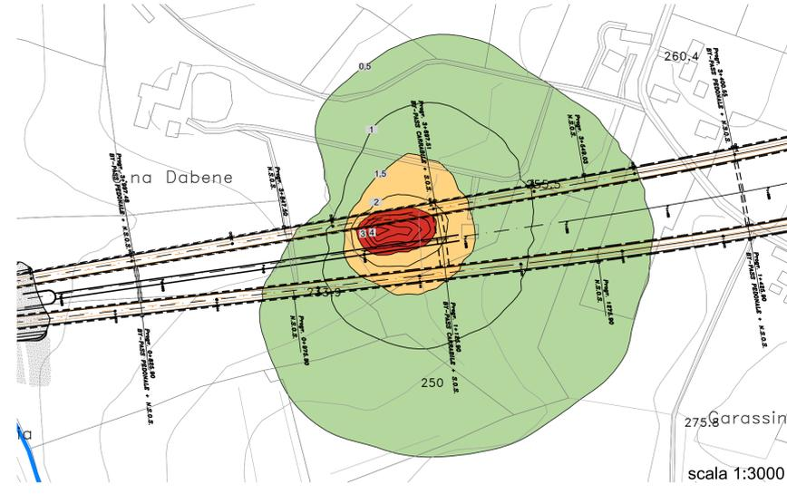
**Fase 1:** Previsione di abbassamento del livello della falda dell'acquifero dei gessi ad un anno dallo scavo del cunicolo centrale alle due canne della Galleria di Verduno.
