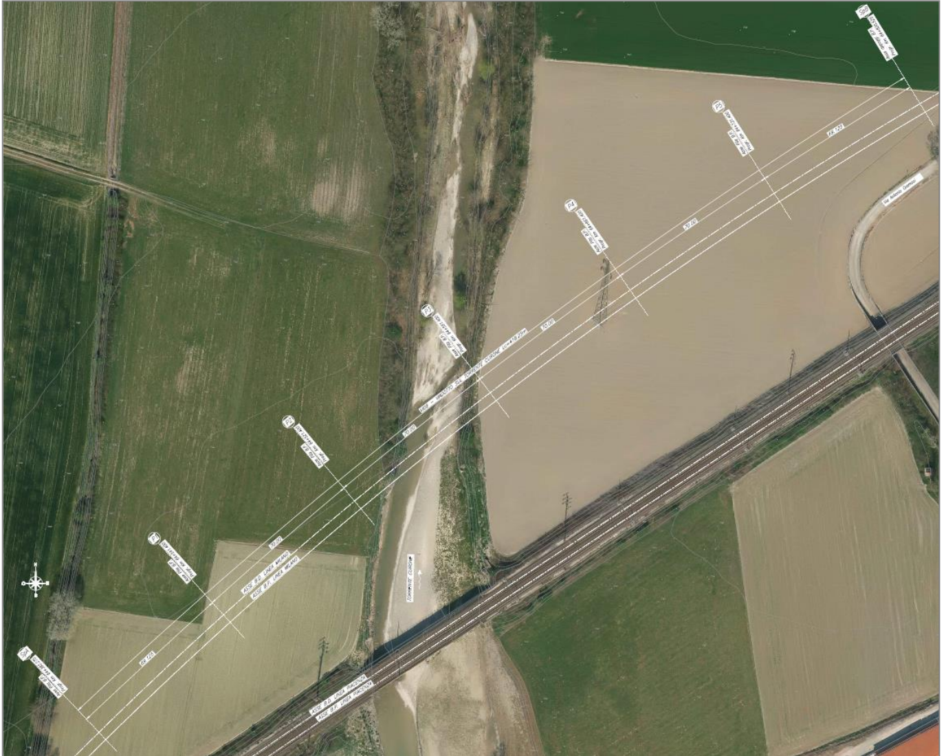
Figura 1 – Stato di fatto in corrispondenza del ponte ferroviario (Linea Piacenza) esistente sul Torrente Curone con individuazione dei binari in progetto (Linea Milano): stralcio planimetrico (a sinistra direzione Genova e a destra direzione Milano)
