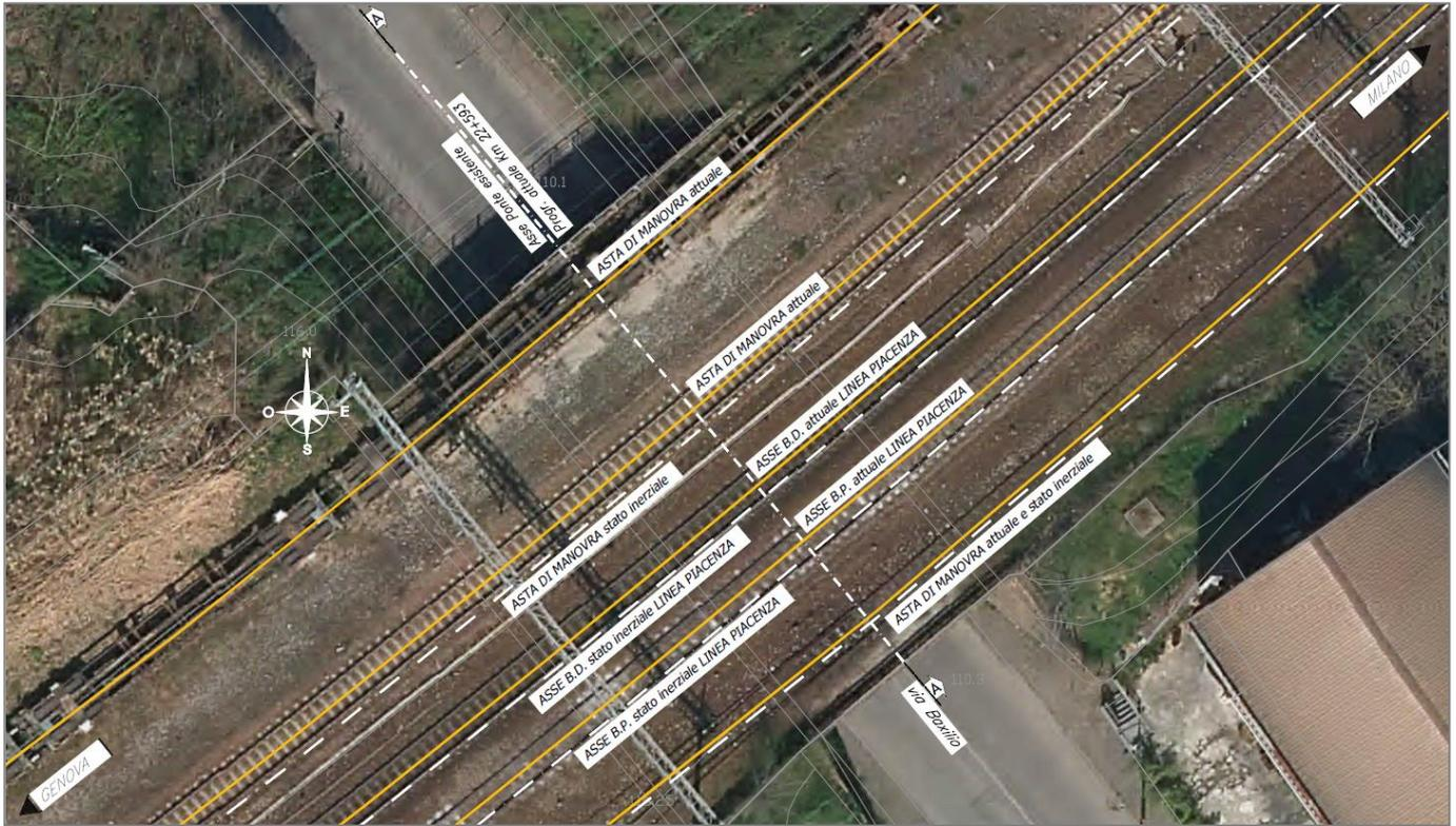
Figura 5 – Configurazione ferroviaria attuale in corrispondenza del ponte ferroviario esistente su via Baxilio con individuazione dei binari attuali (in giallo) e dei binari di stato inerziale (in bianco) afferenti alla Linea Piacenza ed alle aste di manovra: stralcio planimetrico
