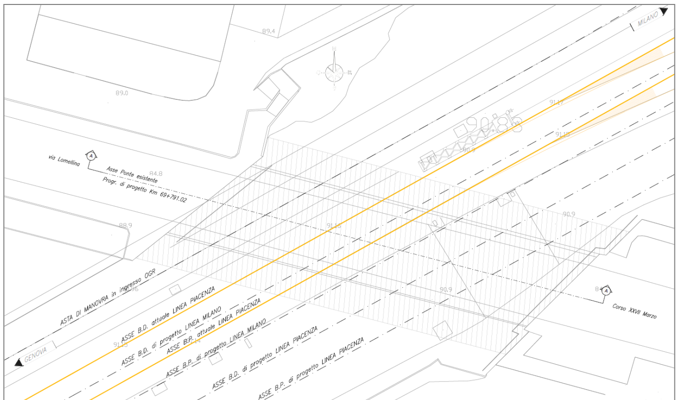
Figura 9 – Configurazione ferroviaria di progetto in corrispondenza del ponte ferroviario esistente su Corso XXVII Marzo/via Lomellina con individuazione dei binari di progetto (in nero) afferenti alla Linea Piacenza, alla Linea Milano ed all'asta di manovra in ingresso OGR: stralcio planimetrico
