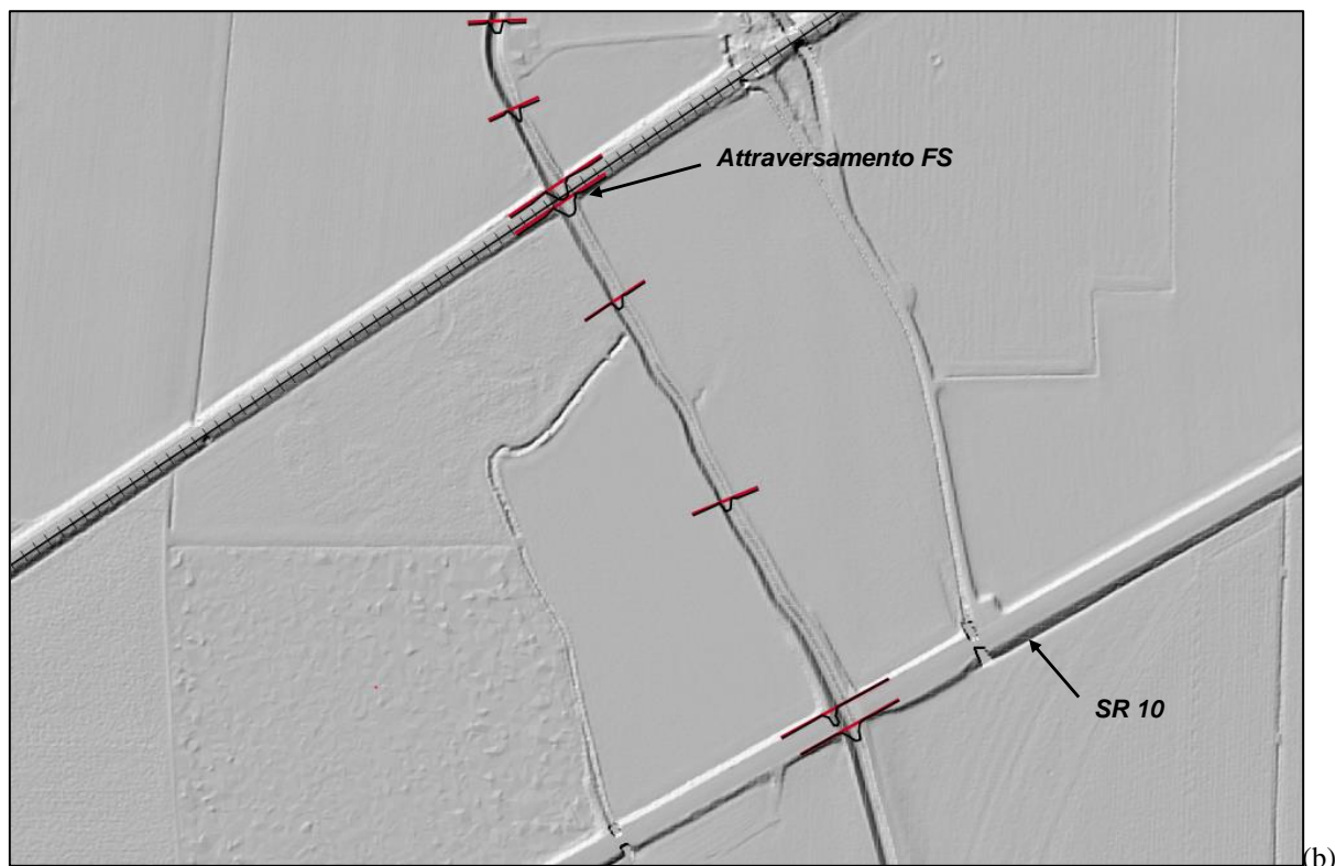
Figura 17: Estratto del DTM da Lidar (a) e del DTM ottenuto integrando il Lidar con le sezioni trasversali (b), lungo il torrente Limbione, a monte dell'attraversamento ferroviario
