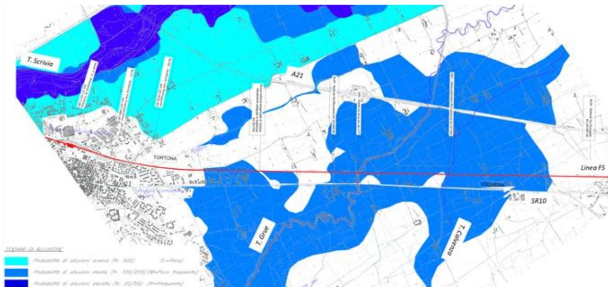
Tale scenario ha reso necessario uno studio idraulico bidimensionale (2D) di dettaglio, finalizzato alla determinazione delle aree potenzialmente inondabili e dei corrispondenti livelli idrici, per i tempi di ritorno di riferimento, sviluppato in accordo anche alle indicazioni avanzate dalla Regione Piemonte nelle varie riunioni tenutesi nel corso dello sviluppo del progetto, propedeutiche alla definizione (e ad una preliminare approvazione) della soluzione progettuale adottata.
