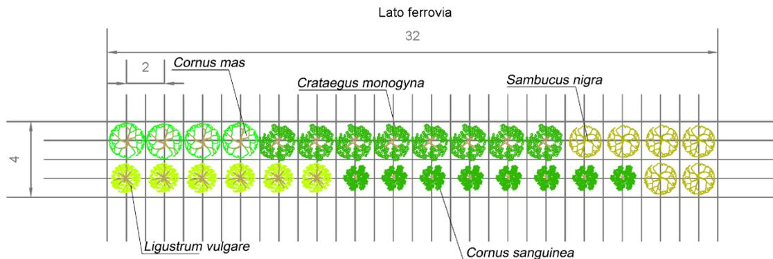
Figura 4-2: Schema d'impianto del tipologico SA
