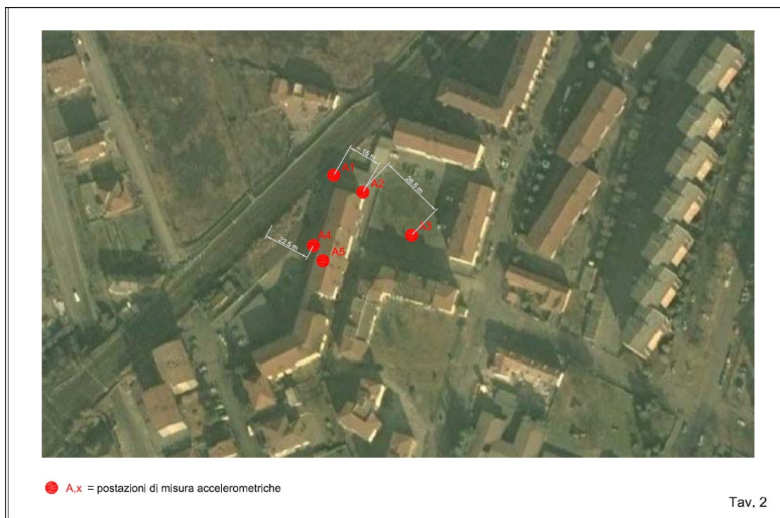
Figura C2: Sezione di misura 2 (Tortona). Inquadramento del sito e posizione dei sensori di misura.
