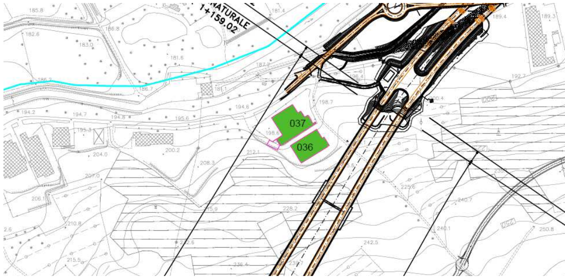
Figura 12 – Planimetria edifici interferenti (Imbocco Alba)
