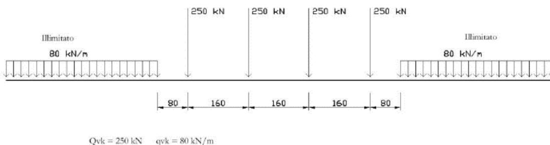
Carichi concentrati: quattro assi da 250 kN disposti ad interasse di 1,60 m;
