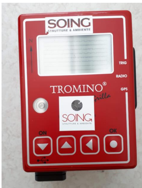
Figura 2.3.2.1: Tromografo per la misura microtremori - TROMINO©Engi.
