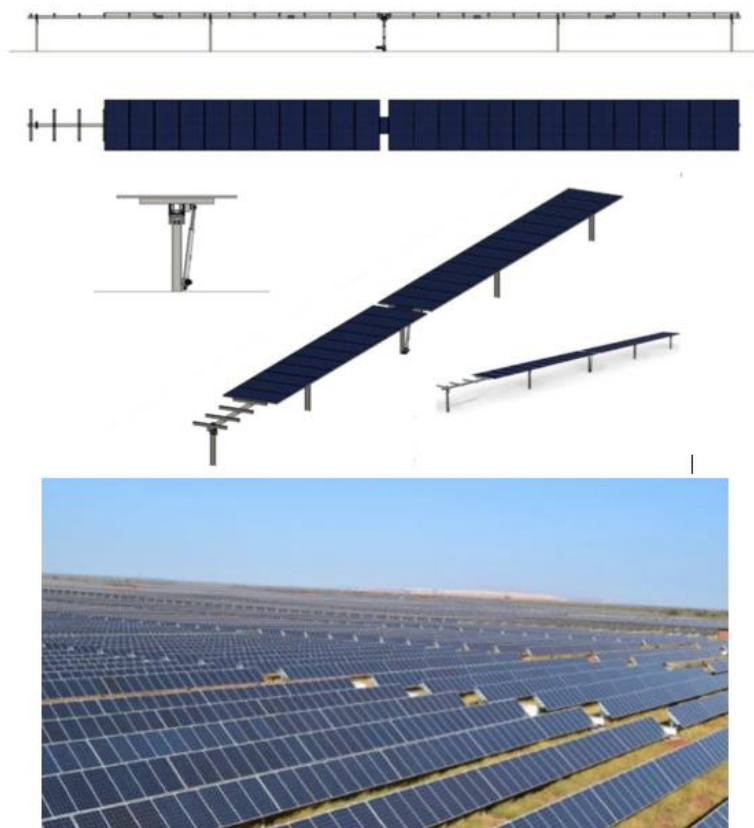
Figura 2-2 Modello 3D e fotografie esemplificative dei trackers utilizzati nel progetto
