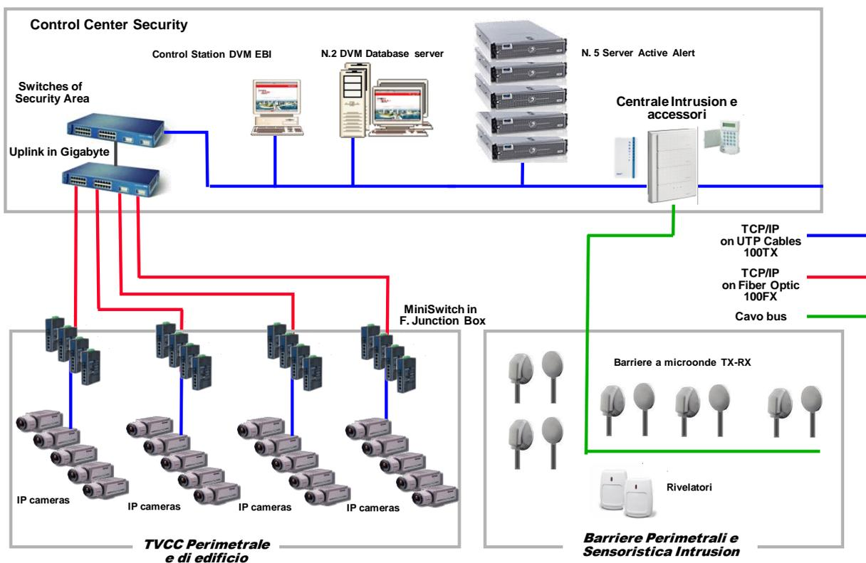
**Figura 8 – Schema del sistema di sorveglianza**
