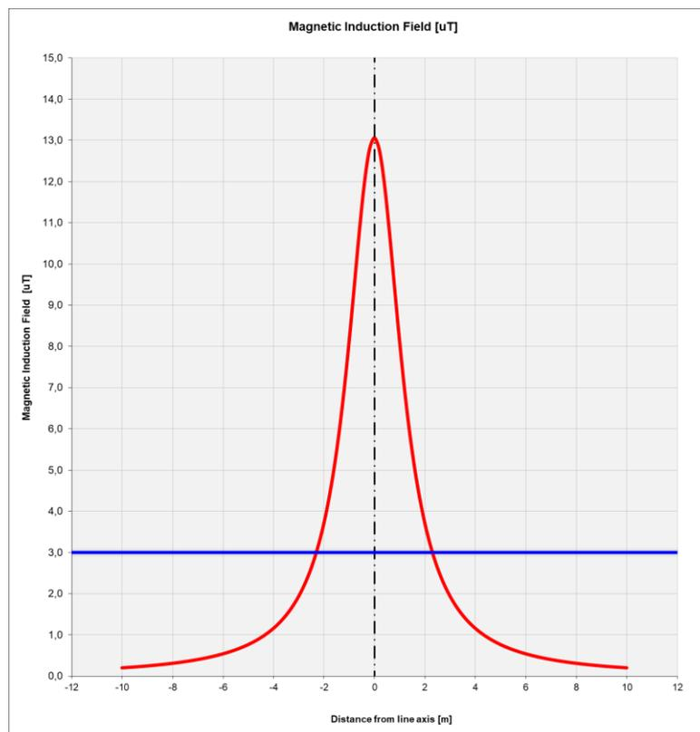
**Figura 5: Andamento dell'induzione magnetica prodotta dalla linea in cavo per la sezione 2 (due terne a 36 kV)**
