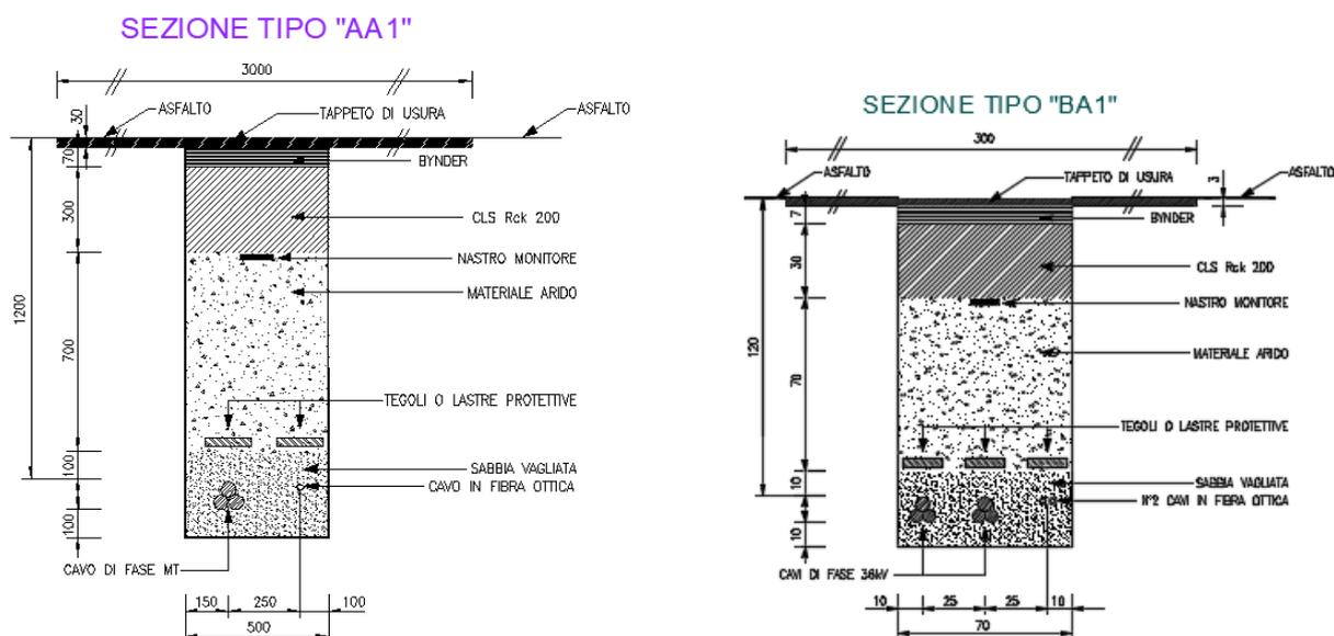
**Figura 2: Sezioni tipiche di posa della linea in cavo su strade asfaltate**
