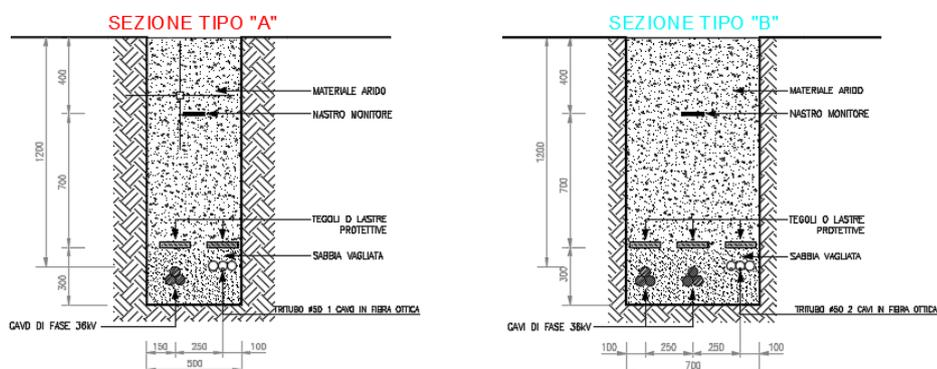
**Figura 1: Sezioni tipiche di posa della linea in cavo su strade sterrate e terreno agricolo**
