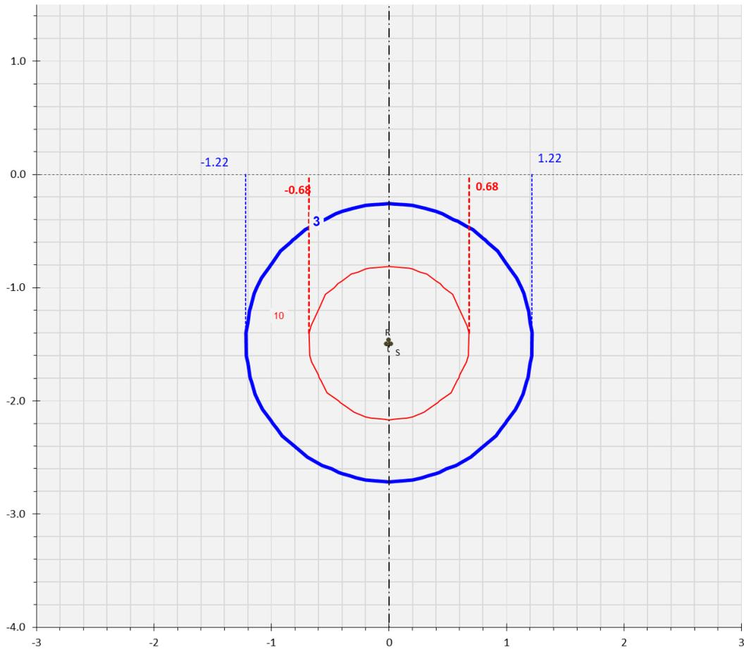
**Figura 7: Curve di equilivello per il campo di induzione magnetica generato dalla linea AT (Sezione 1 – una terna AT)**
