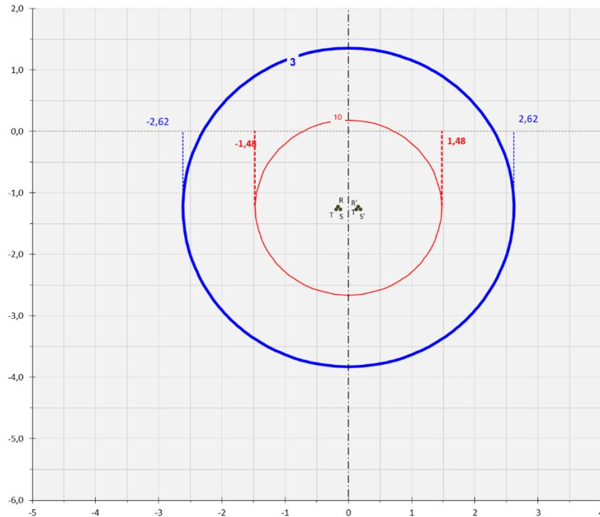
**Figura 8: Curve di equilivello per il campo di induzione magnetica generato dalla linea (Sezione 2 – due terne a 36 kV)**
