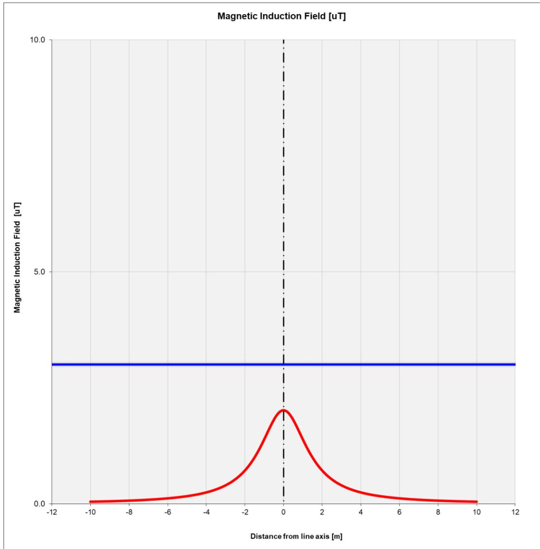
**Figura 4: Andamento dell'induzione magnetica prodotta dalla linea in cavo per la sezione 1 (una terna a 36 kV)**
