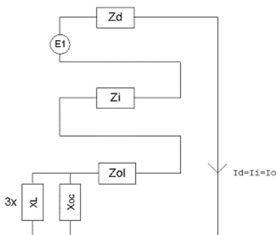
**Figura 5.1: Modellazione guasto monofase con componenti simmetriche**
