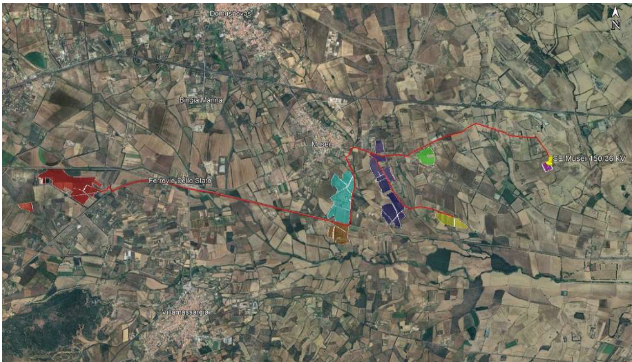
Fig. 7 Sviluppo dei cavidotti con il punto di connessione alla rete
