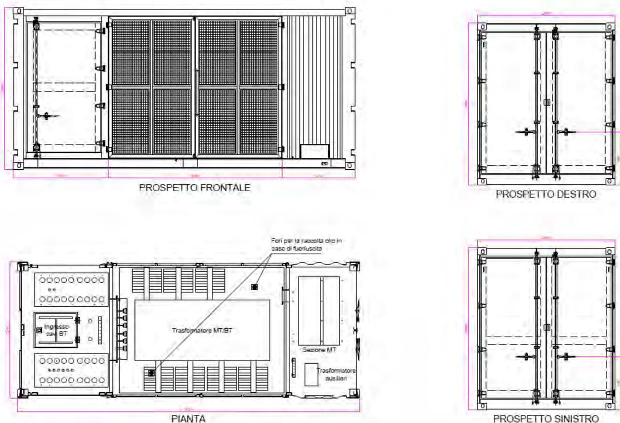
Oltre alle Power Station dislocate in campo sono presenti anche due Cabine Utente che hanno la funzione di "raccolgere" i circuiti provenienti dalle stazioni di trasformazione e farne il parallelo. Pertanto, al loro interno sarà presente principalmente il quadro generale di media tensione dell'impianto oltre che ad altri apparati e al trasformatore MT/BT (100 o 50 kVA) per i servizi ausiliari di campo.
