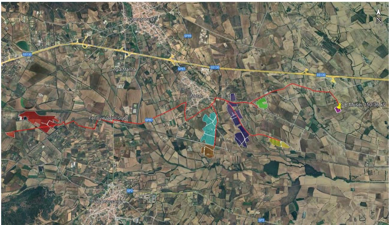
Nella foto satellitare riportata il tracciato dei cavidotti 36 kV esterni all'area di impianto è stato evidenziato in rosso, riguardano, in particolare, sia i collegamenti per il parallelo sulle Cabine Utente sia il collegamento al punto di connessione alla rete nella nuova SE della RTN Musei 150/36 kV.
