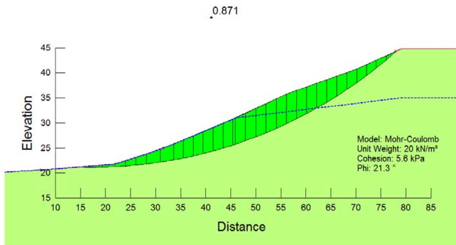
Figura 9.59: Cascina dello Spià – Analisi di stabilità sismica in condizioni “post operam” – Superficie di scivolamento critica e grado di sicurezza \gamma_R per la sezione rappresentativa -b-, intero versante senza intervento di soil nailing
