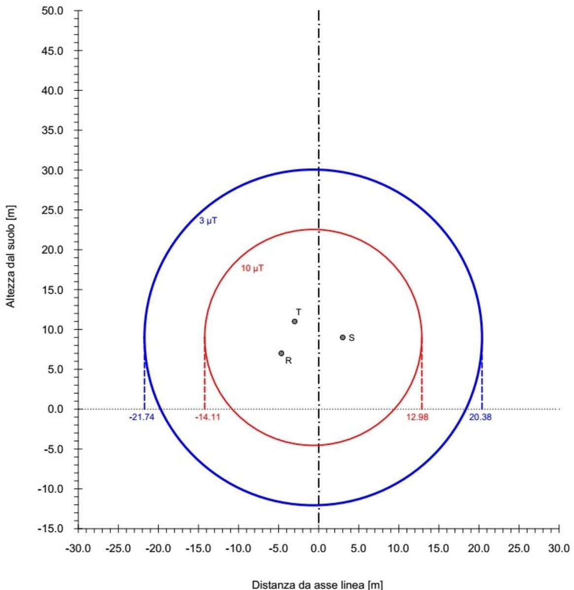
**Figura 3 - Isolinee dell'induzione magnetica nel caso di sostegno unificato**
