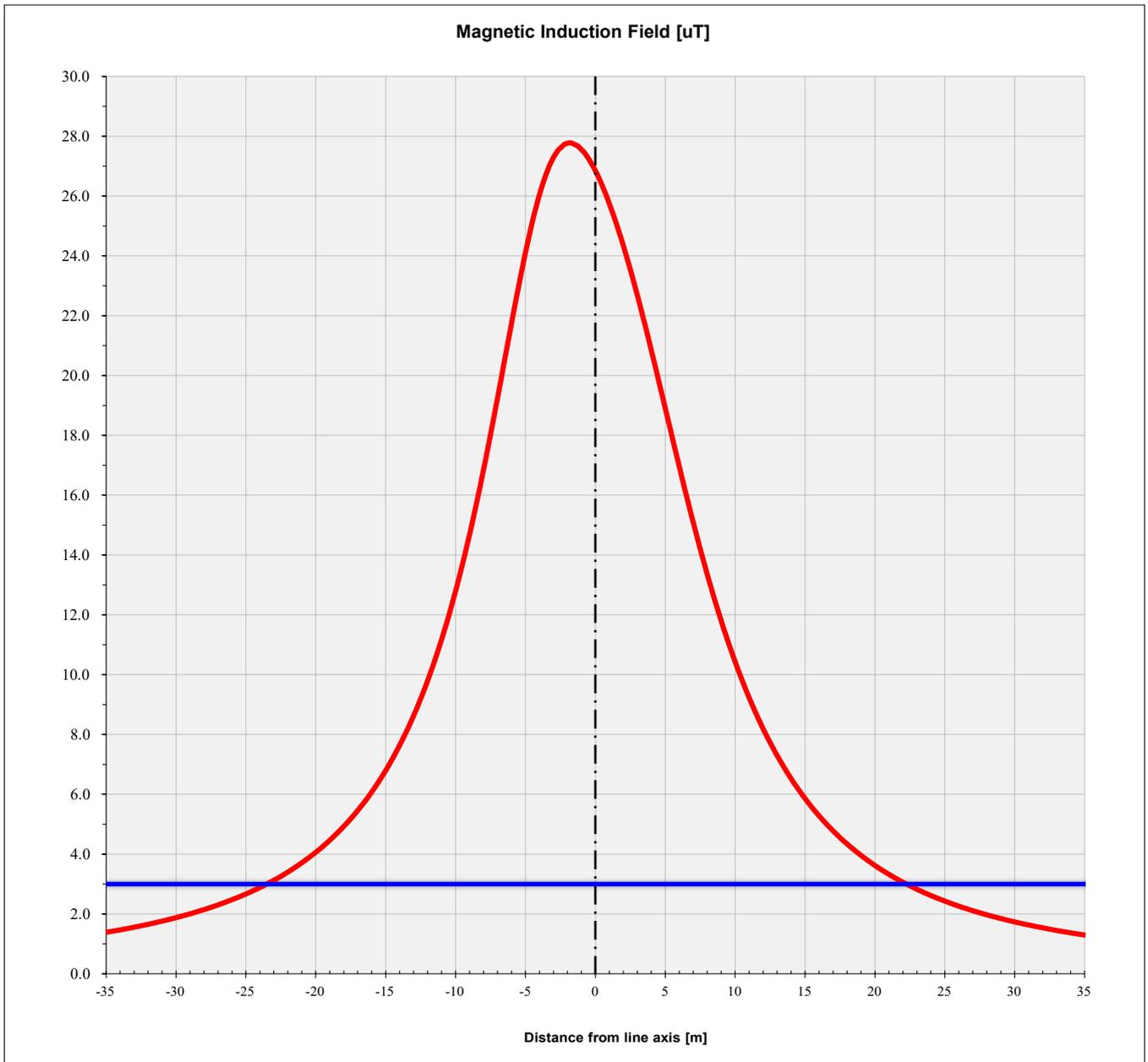
**Figura 1 - Andamento dell'induzione magnetica in una sezione perpendicolare all'asse linea, calcolata a 1,5 m dal suolo in caso di franco minimo (obiettivo di qualità pari a 3  $\mu$ T)**
