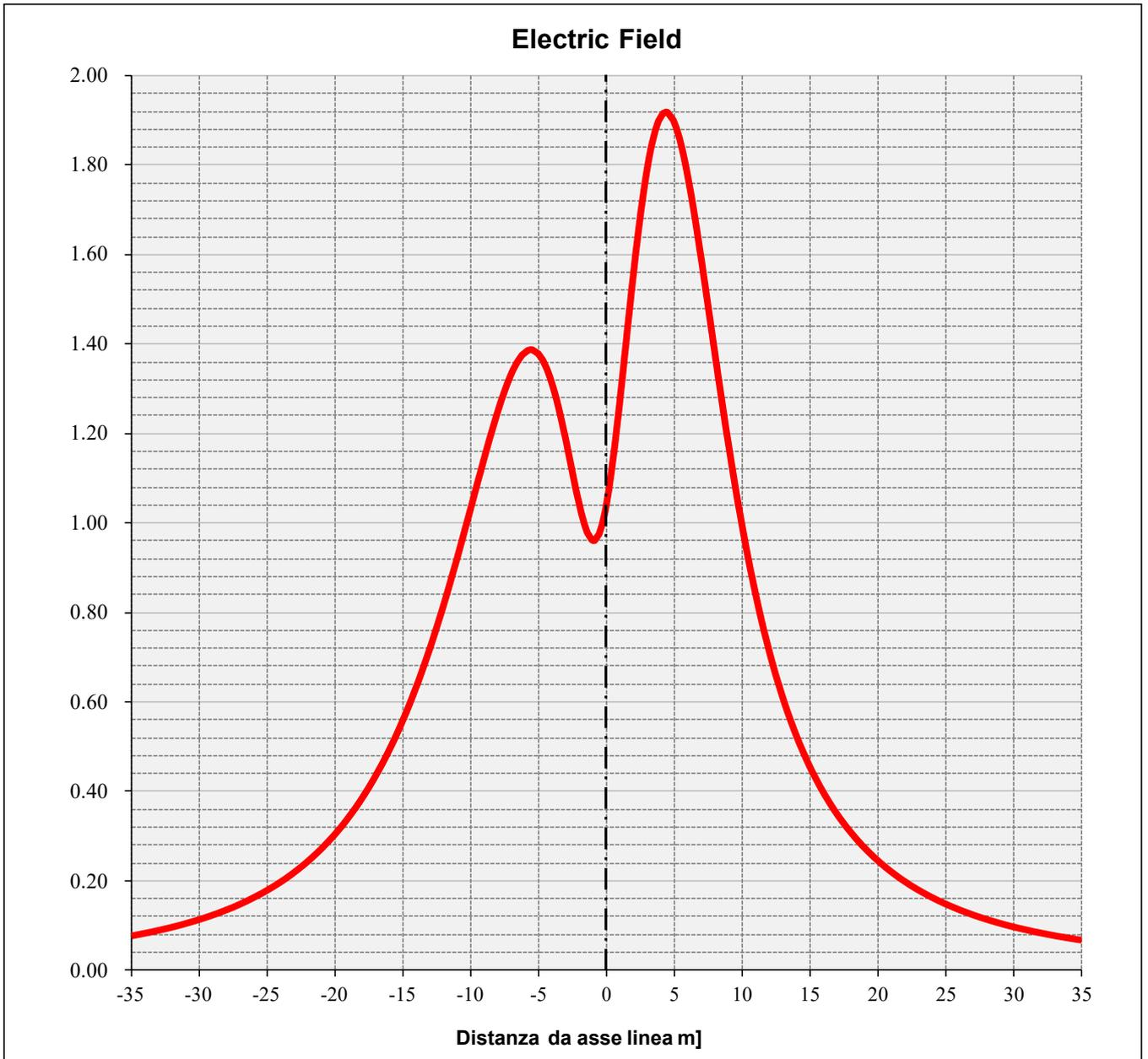
**Figura 2 - Andamento del campo elettrico in una sezione perpendicolare all'asse linea, calcolato ad 1,5 m dal suolo**
