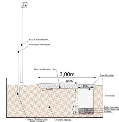
**SEZIONE TIPO STRADA PERIMETRALE CON PARTICOLARE POZZETTO**
