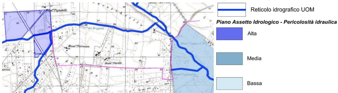
Figura 50 – Carta delle aree a pericolosità idraulica, geomorfologica e del reticolo idrografico UOM
