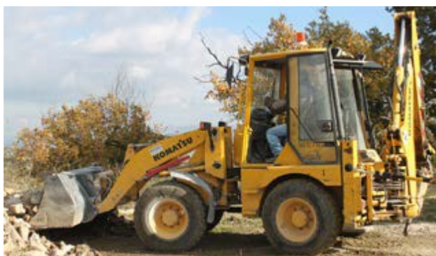
Escavatore caricatore (Terna)
