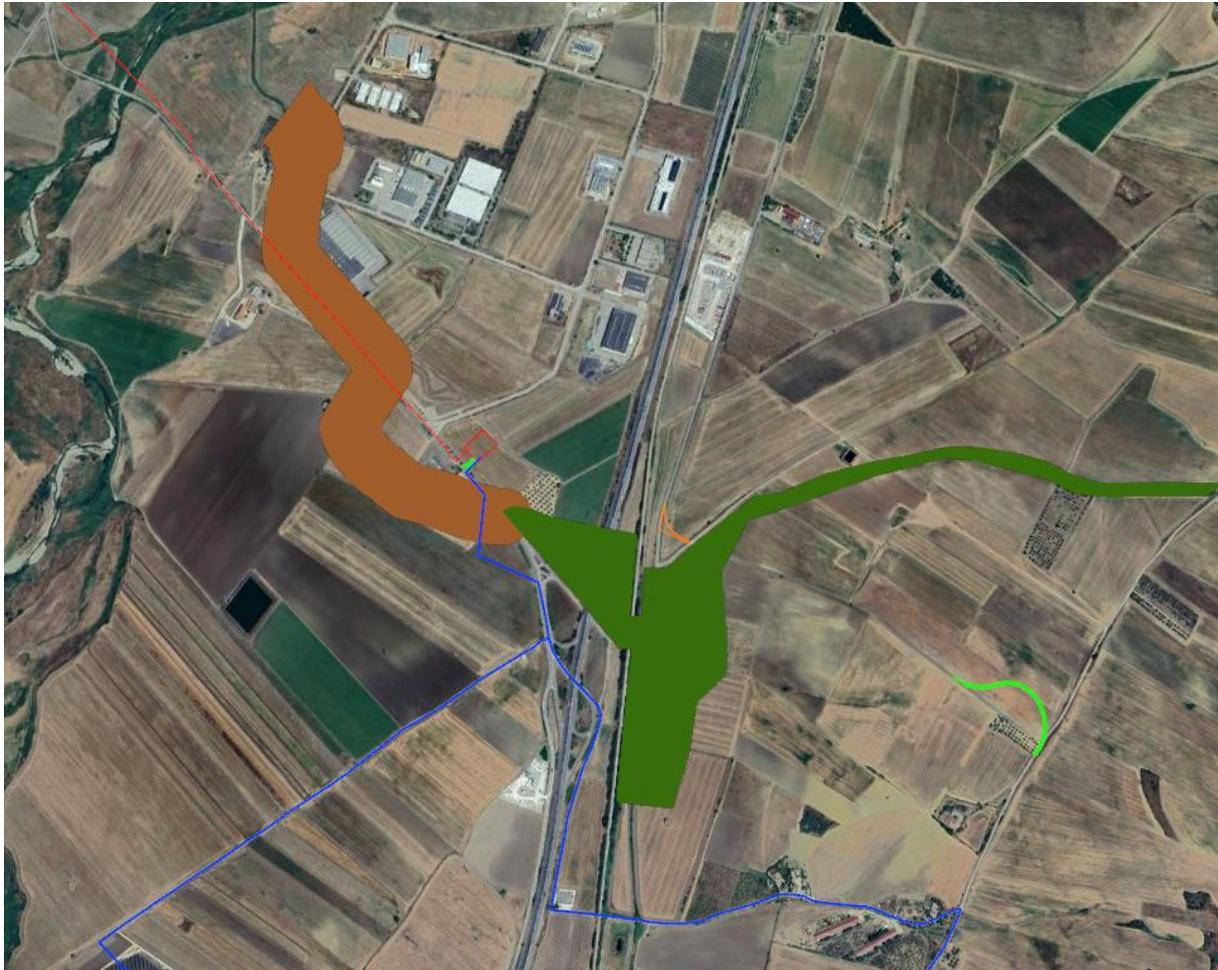
L'interferenza sussiste con l'area color **ruggine** che si raccorda con l'area di color **verde scuro** che corrisponde all'area a pericolosità idraulica del PAI.
