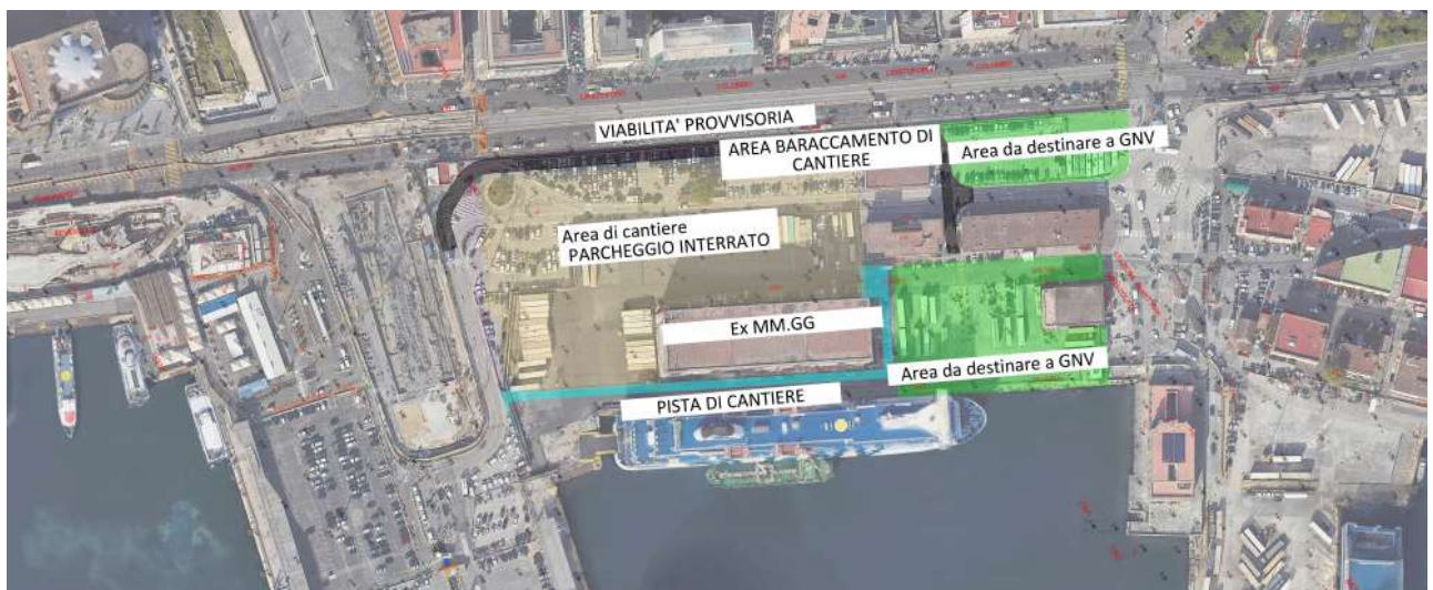
Figura 15 - Planimetria viabilità provvisoria di cantiere
