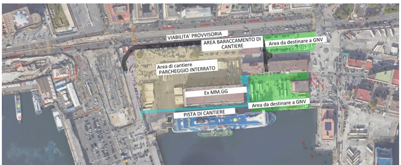
Figura 2 - Planimetria viabilità provvisoria di cantiere
