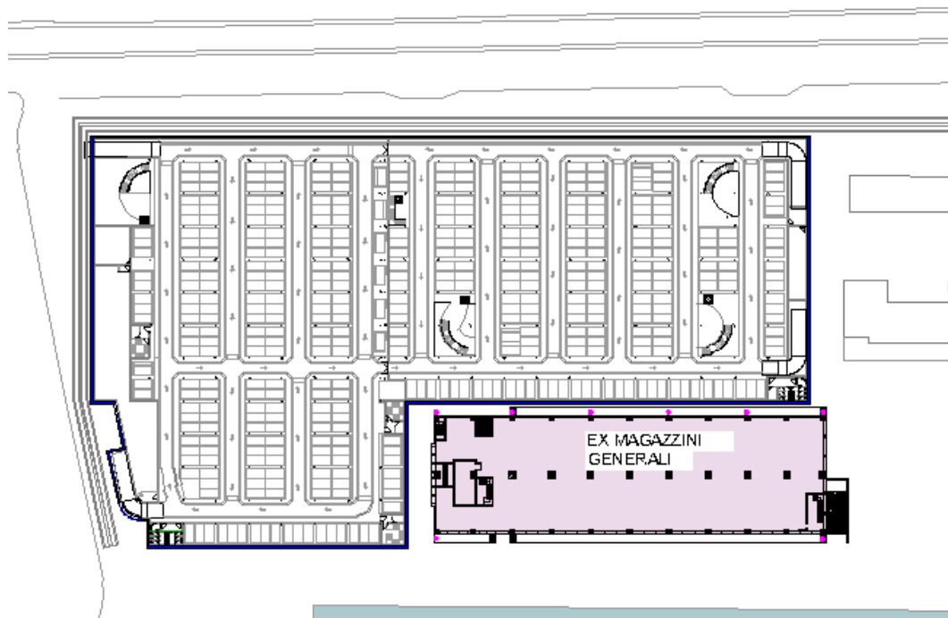
Figura 4 - Planimetria di progetto Parcheggio interrato con ubicazioni microprismi
