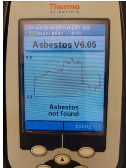
Campione di polistirene (polistirolo) e risultato analisi in campo con spettrometro NIR portatile
