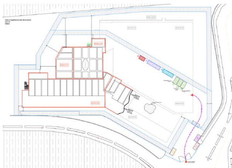
Figura 7 - Riperimetrazione del ponteggio di protezione e avanzamento della demolizione del Blocco B1.
