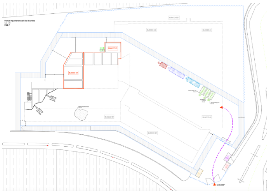
Figura 9 - Fase 7: completamento della demolizione del Blocco B2.
