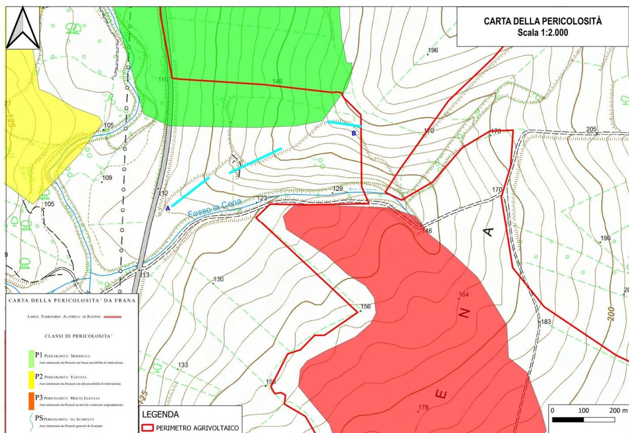
Figura 3- Particolare della Carta della Pericolosità in cui è indicata con le lettere A e B l'estensione della scarpata che non interessa il perimetro del futuro impianto da realizzare.
