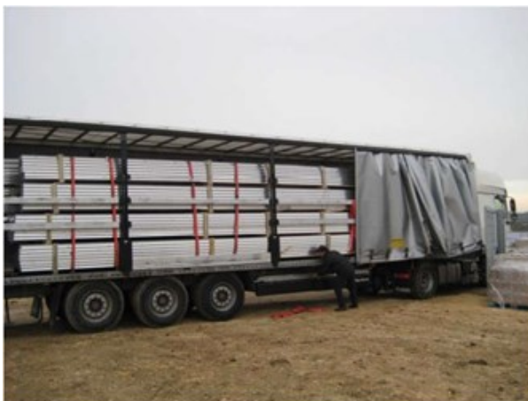
Figura 20 | Autoarticolato tipo per consegna struttura portante
